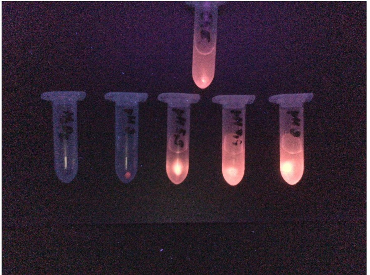
Obrázek 19. Zhášení fluorescence kvantových teček při různém pH. Zleva: peroxid vodíku (pozitivní kontrola – zháší fluorescenci), roztok o pH 3,0, roztok o pH 5,5, roztok o pH 7,4 a roztok o pH 9,0. Nahoře roztok obsahující AChE po proběhlé enzymové reakci.
