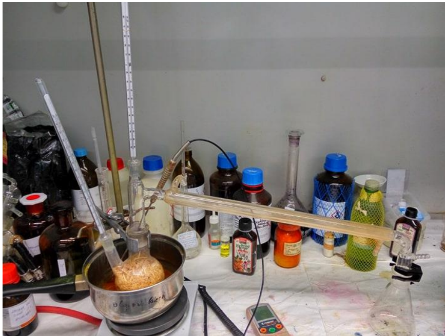
Obrázek 11: Aparatura pro hydrolýzu traviny – Foto: Pavel Matějčík (2018)
