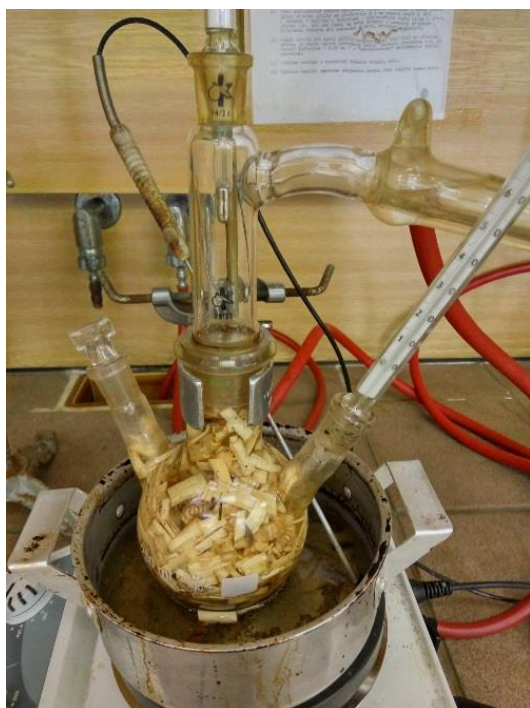
Obrázek 10: Sulfonační banka naplněná suchou travinou – Foto: Pavel Matějčiek (2018)
