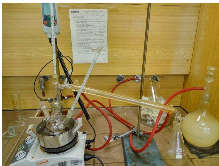
Obrázek 7: Aparatura pro hydrolýzu papíroviny – Foto: Pavel Matějčik (2018)
