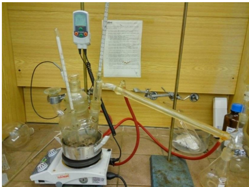
Obrázek 6: Aparatura pro hydrolýzu papíroviny – Foto: Pavel Matějček (2018)
