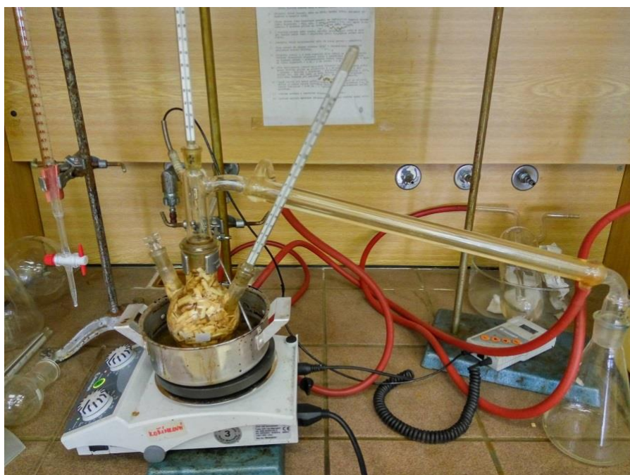
Obrázek 9: Aparatura pro hydrolýzu suché traviny – Foto: Pavel Matějčiek (2018)
