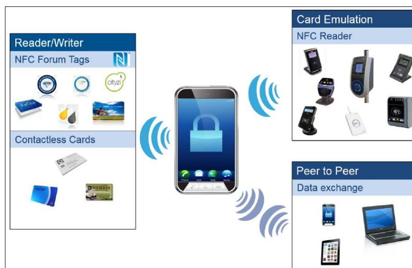
Obrázek 16: NFC zařízení (controller) pracující ve třech módech. Zdroj: [25].
