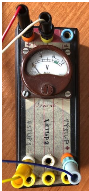
Obrázek 26: Zařízení simulující reálnou soustavu třetího řádu
