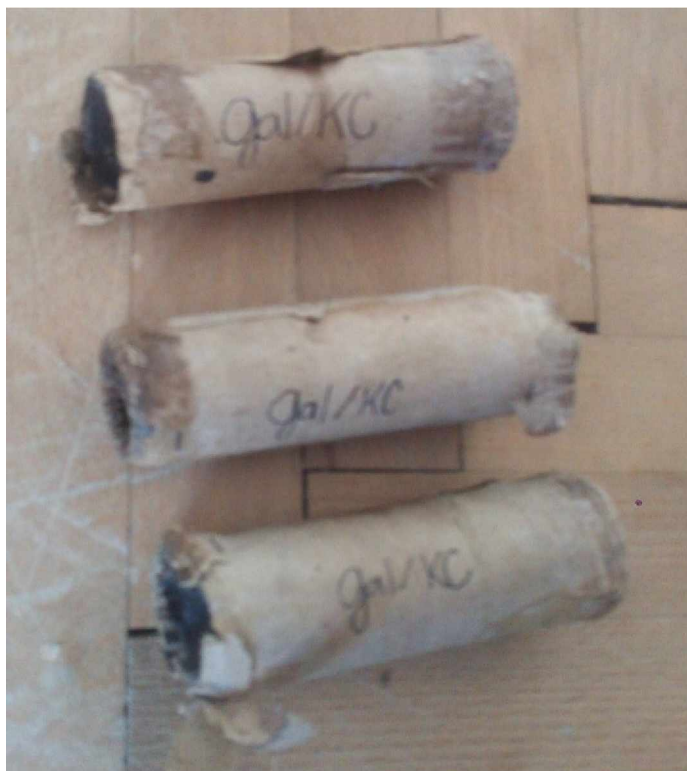
Obrázek 19 Náložky po neúspěšné iniciaci slože Gal/KC.
