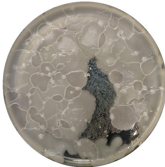
Obrázek 19 Masivní nárůst na misce při experimentu s bakterií Pseudomonas fluorescens
