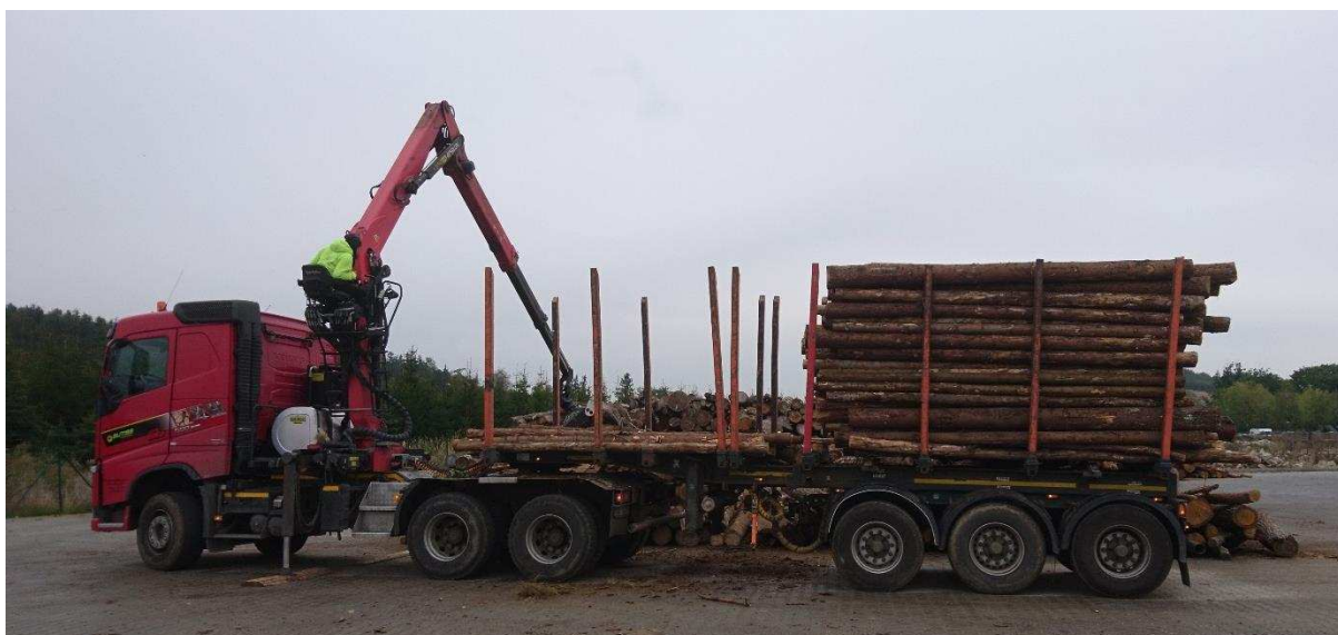
obr. 8 Tahač Volvo FH s hydraulickou rukou a návěsem UMIKOV překládající dřevní hmotu
