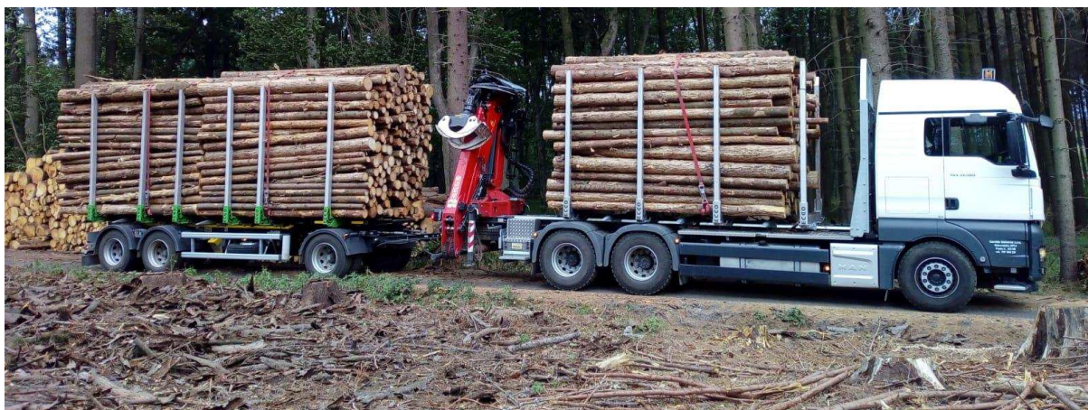
obr. 7 Klanicové vozidlo MAN TGX s hydraulickou rukou a klanicovým přívěsem DOLL
