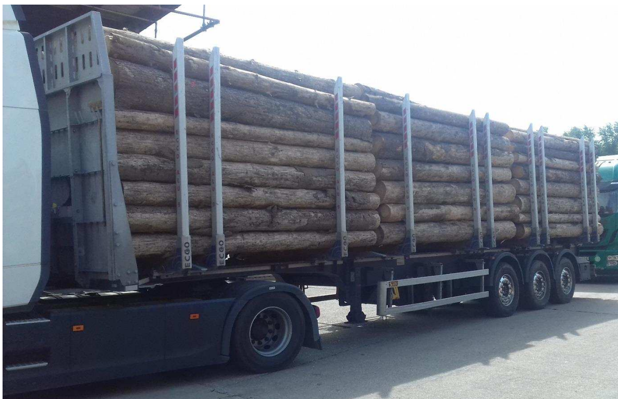
obr. 10 Klanicový návěs SVAN s naloženou dřevní hmotou délky 4 metry
