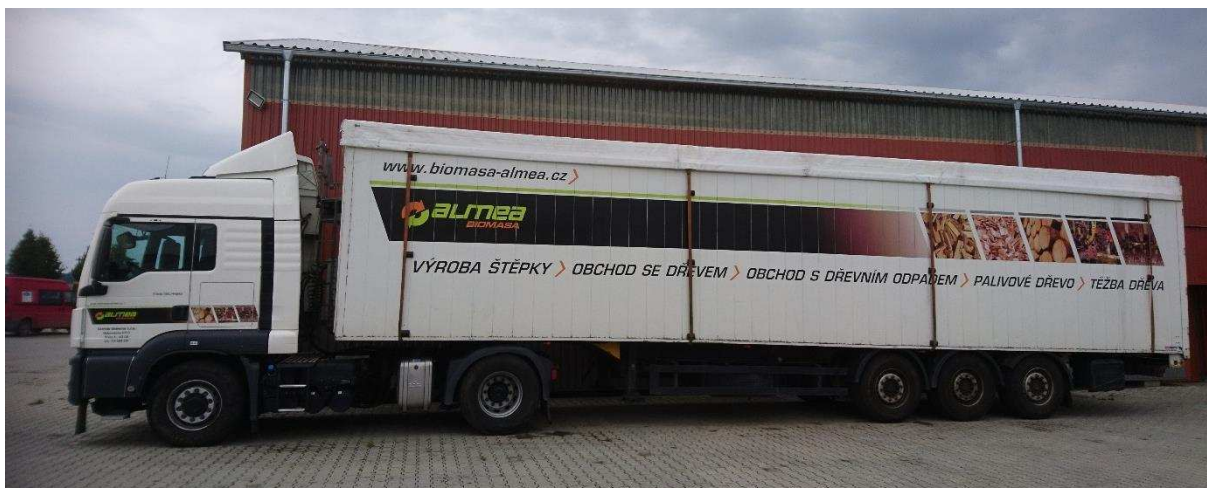
obr. 9 Tahač MAN TGX s pohonem HydroDrive a návěsem s posuvnou podlahou
