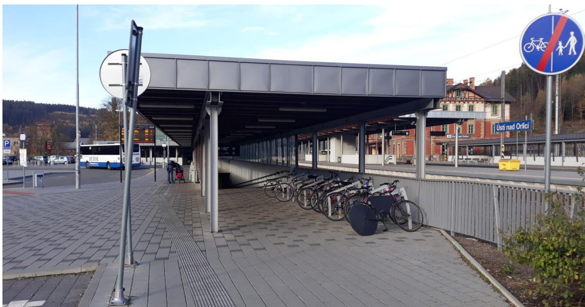
Obrázek 5: Příklad rozumného cykloparkování (dostupnost, vhodný tvar stojanu, viditelnost, střecha, zachování volného průchodu), Ústí nad Orlicí.
