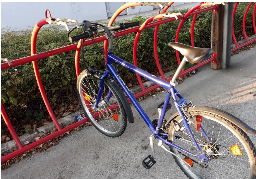
Obrázek 4: Cyklostojan kombinující umístění řídítek do dvou výšek a tím snížení nutného bočního odstupu, včetně oka pro delší zámek, Ebenfurth, Rakousko.
