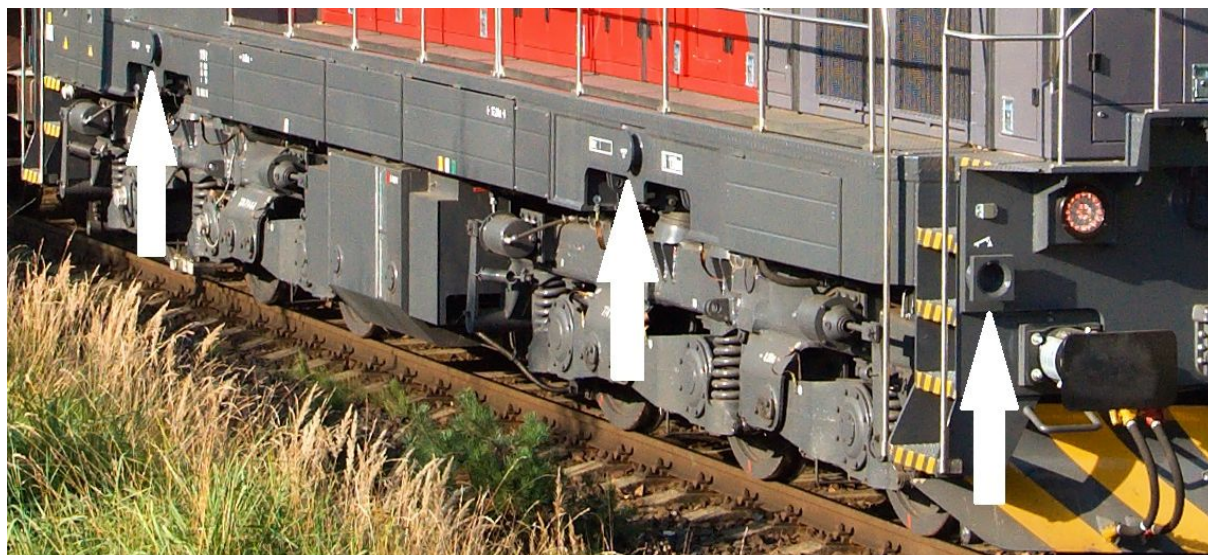
Obr. 24: Zvedací místa na hlavním rámu modernizované lokomotivy řady 774.714. Zcela vpravo je místo pro nakolejování, zbývající dvě označená místa slouží ke zvedání celé lokomotivy.
