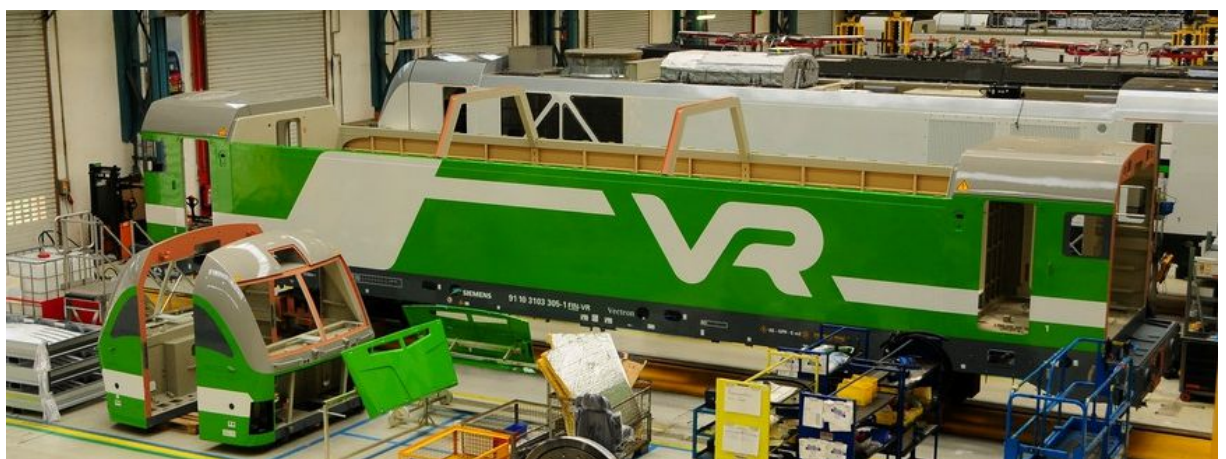
Obr. 31: Lokomotiva Vectron během montáže. Vlevo jsou viditelná samostatně montovaná čela kabiny, připravená k montáži ke skříni lokomotivy. Autor: Peider SwissTrip [35].
