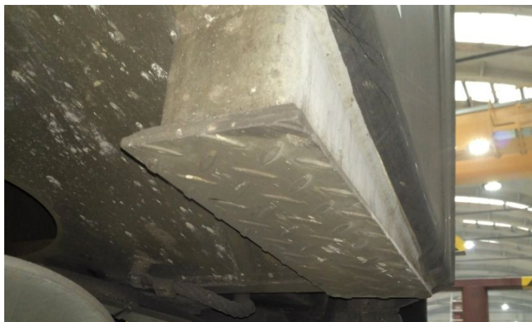
Obr. 26: Detail provedení nakolejovacího místa u čelníku lokomotivy Siemens EuroRunner.
