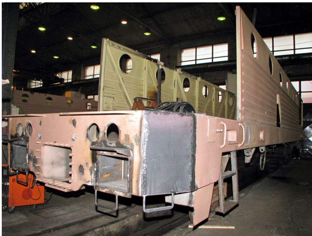
Obr. 28: Pohled na hlavní rám a bočnice lokomotivy řady 753.754 během zásadní modernizace. Autor: PhDr. Zbyněk Zlinský [32].
