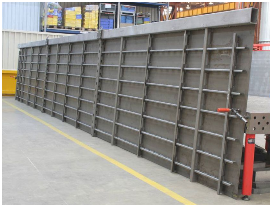
Obr. 30: Stavba bočnice lokomotiv Vectron. Autor: RollingOnRails [34].
