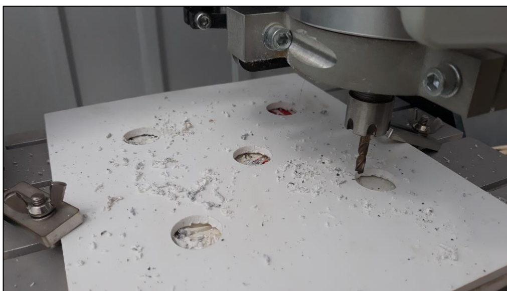
Obr. 11.1 – Výsledek testu obrábění tvrdé plastové desky s parametry z tab. 11.4
