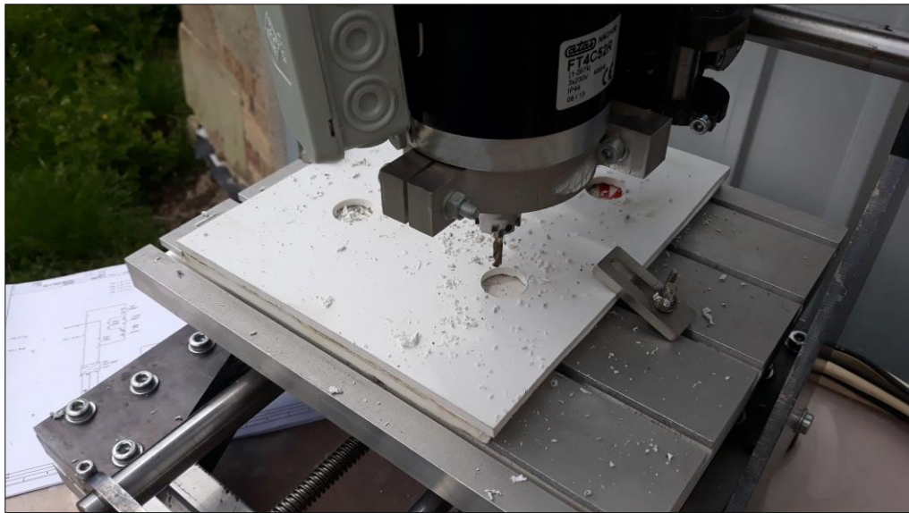
Obr. 3.1 – Testování obrábění tvrdého plastu
