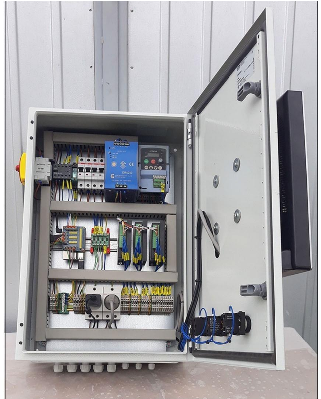
Obr. 9.14 – Příprava kabeláže osazovací desky (vlevo), kompletní rozvaděč (vpravo)
