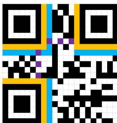
Obrázek 38 – QR kód s odstraněnou maskou (zdroj: [Autor])
