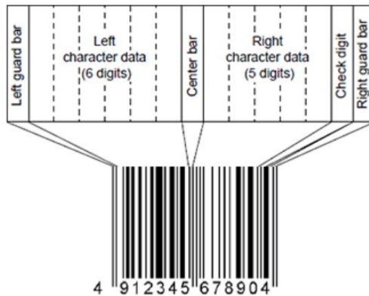
Obrázek 30 – Rozložení čar čárového kódu EAN-13 (zdroj: [41])
