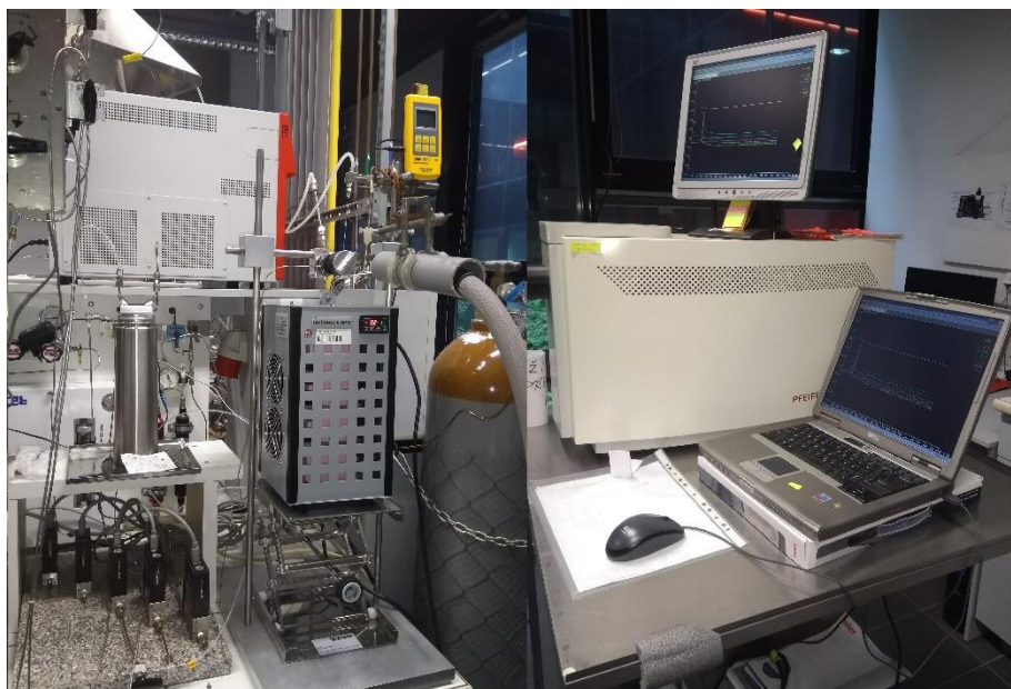
Obr. 7.1 Aparatura pro měření metodou ZLC v laboratořích katedry fyzikální chemie UPCE
