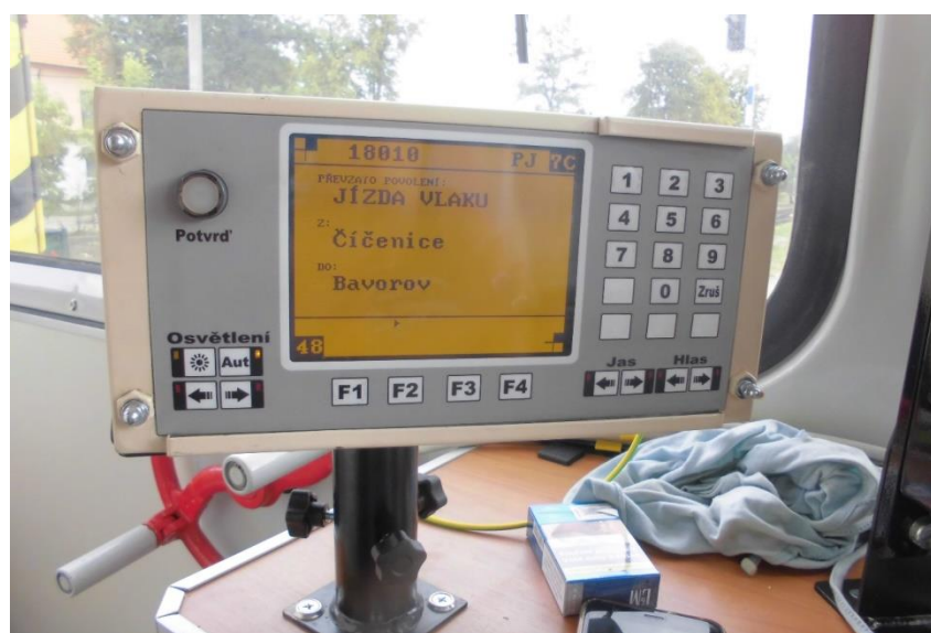
Obrázek 6 – Zobrazovací jednotka RBV umístěná na HV informující o aktuálním převzatém povolení
