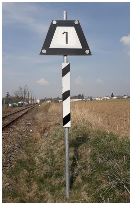
Obrázek 5 – Návěst Hranice dopravní s uvedením čísla vjezdové koleje, pro kterou jsou výměny přestaveny v základní poloze
