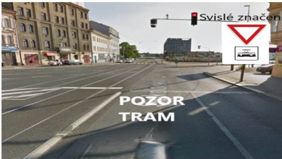
Obrázek 25 Navrhované řešení svislého a vodorovného značení na křižovatce Sokolovská – Pod Plynojemem (autor, 2019)
