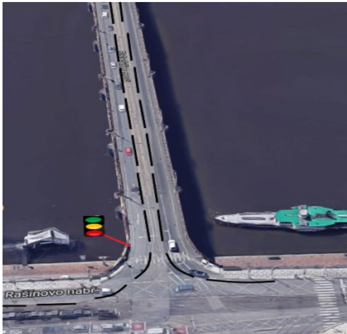
Obrázek 29 Navrhované řešení betonových zábran oddělujících tramvaje a automobily (autor,2019)
