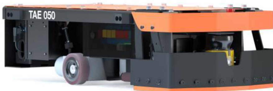
Obrázek 34 Autonomní nosič nákladů TAE050 (Toyota, 2019c)
