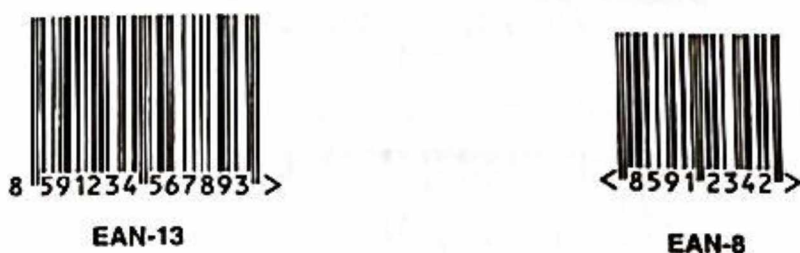
Obrázek 6 Základní formáty čárových kódů systému EAN (Sixta a Mačát, 2005)
