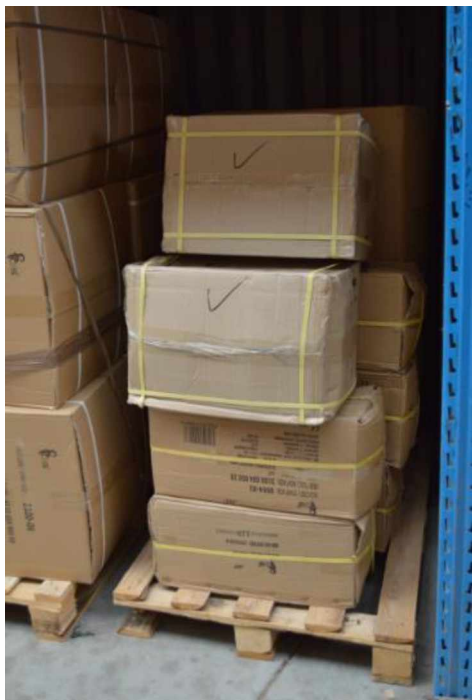
Obrázek 17 Nevhodné skladování na paletě (autor)
