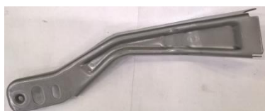
Obrázek 29 Držák vzduchového kanálu RL a uložení dílů v Bultu 1208 (autorka, 2019)
