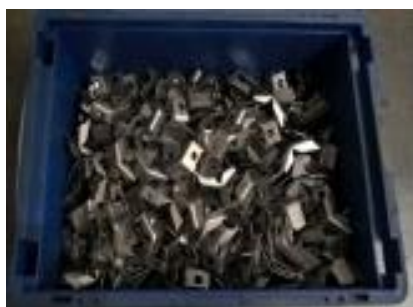
Obrázek 55 Držák přihrádky u spolujezdce pravý LL před změnou (595 dílů) a po změně (990 dílů) (autorka, 2019)
