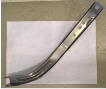
Obrázek 32 Kanál u spolujezdce RL a uložení dílů v obalu Bult 1208 (autorka, 2019)
