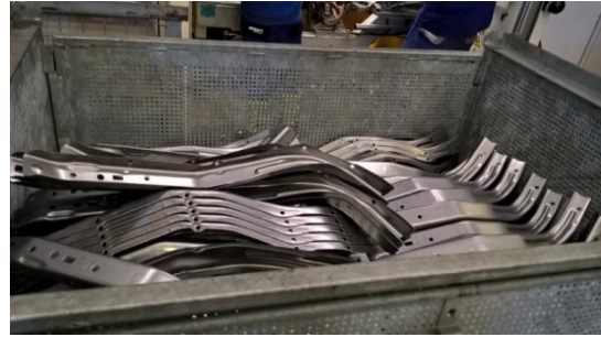
Obrázek 32 Kanál u spolujezdce RL a uložení dílů v obalu Bult 1208 (autorka, 2019)
