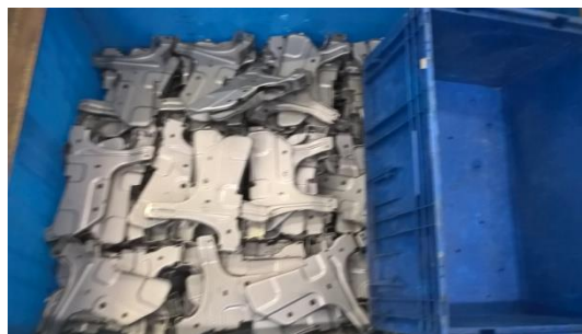
Obrázek 27 Držák u spolujezdce LL a uložení dílů v obalu Gitterbox (autorka, 2019)
