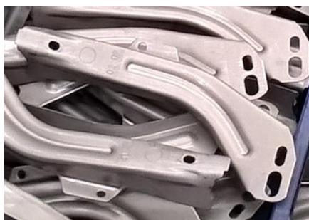
Obrázek 28 Držák vzduchového kanálu LL a uložení dílů v Bultu 1208 (autorka, 2019)
