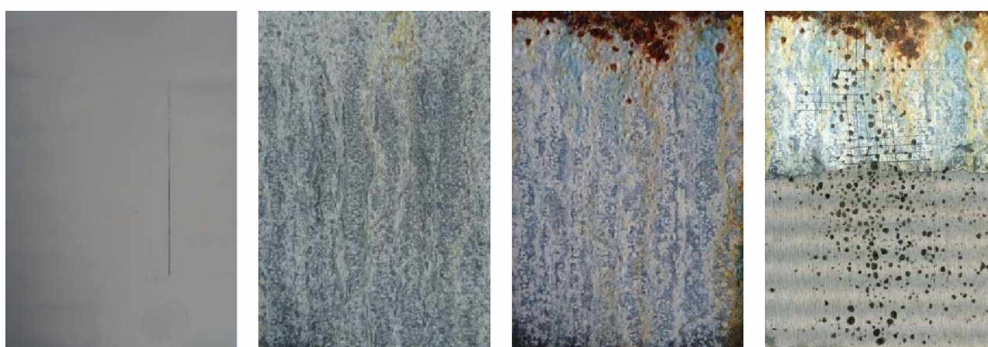
Nátěrové filmy s obsahem ZnFe_2O_4/PPY OKP=1% před expozicí, po 120 hodinové expozici, 1056 hodinové expozici a ocelový panel po odstranění nátěrového filmu
