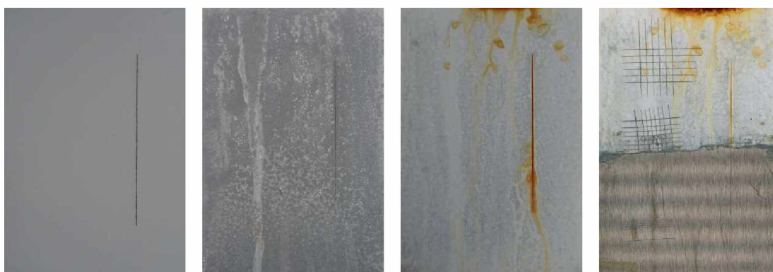
Nátěrové filmy s obsahem Litoponu OKP=3 % před expozicí, po 120 hodinové expozici, po 1848 hodinové expozici, ocelový panel po odstranění nátěrového filmu
