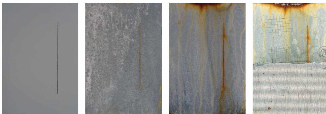
Nátěrové filmy s obsahem ZnFe 2 O 4 /PANI OKP=5 % před expozicí, po 120 hodinové expozici, po 1848 hodinové expozici, ocelový panel po odstranění nátěrového filmu
