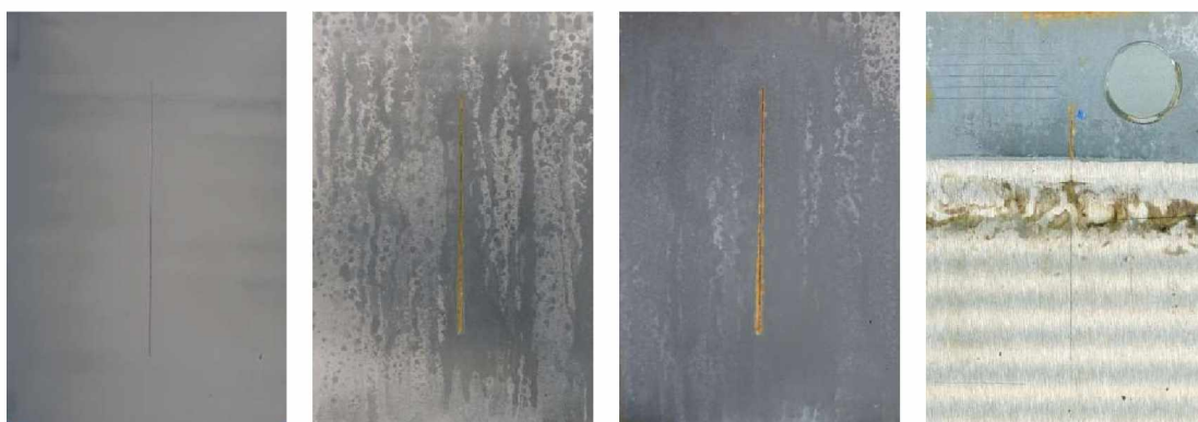
Nátěrové filmy s obsahem WS2 OKP= 5% před expozicí, po 120 hodinové expozici, po 600 hodinové expozici, ocelový panel po odstranění nátěrového filmu
