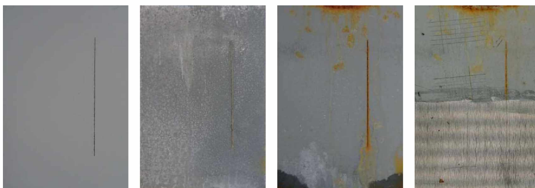
Nátěrové filmy s obsahem MoS 2 OKP=3 % před expozicí, po 120 hodinové expozici, po 1848 hodinové expozici, ocelový panel po odstranění nátěrového filmu
