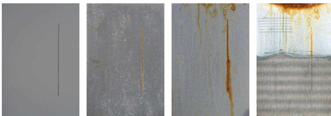
Nátěrové filmy s obsahem ZnS OKP=3% před expozicí, po 120 hodinové expozici, po 1848 hodinové expozici, ocelový panel po odstranění nátěrového filmu
