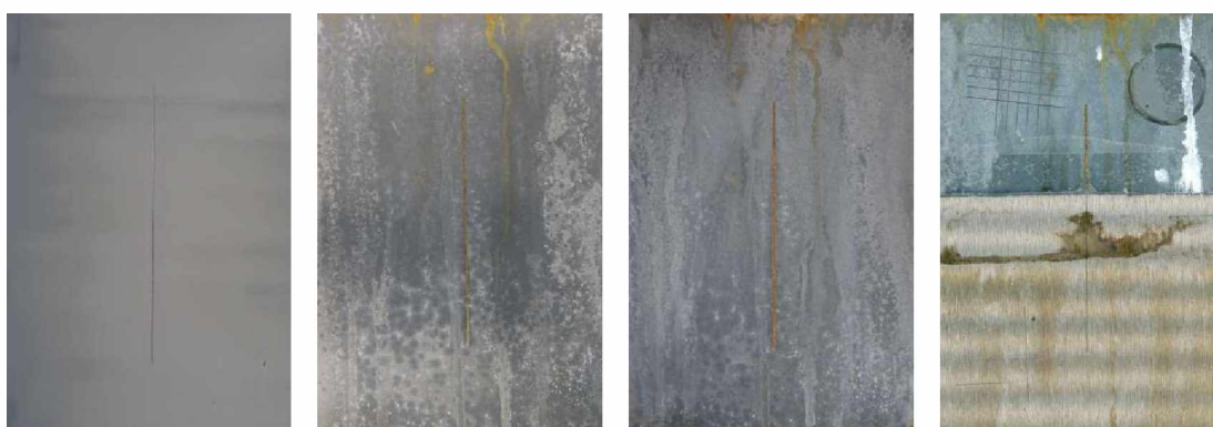
Nátěrové filmy s obsahem ZnFe_2O_4 /PANI OKP= 10% před expozicí, po 120 hodinové expozici, po 600 hodinové expozici, ocelový panel po odstranění nátěrového filmu
