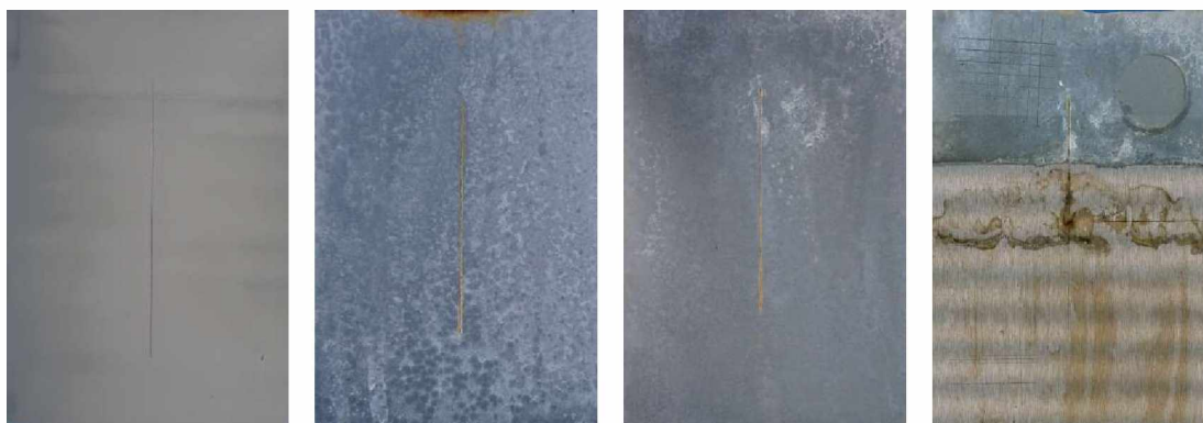
Nátěrové filmy s obsahem Litopon/PPY OKP= 3% před expozicí, po 120 hodinové expozici, po 600 hodinové expozici, ocelový panel po odstranění nátěrového filmu
