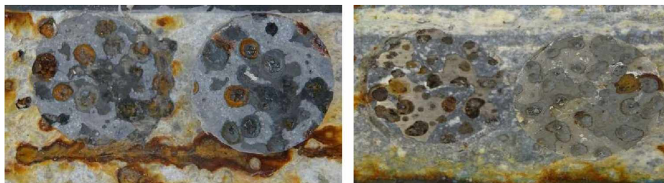
OBRÁZEK 20: Ukázka terčíku a podkladu po odtrhové zkoušce expozice v atmosféře neutrální solné mlhy. Vlevo organický povlak s obsahem ZnS/PPY OKP 5 % a vpravo organický povlak s obsahem ZnFe 2 O 4 OKP 3 %.
