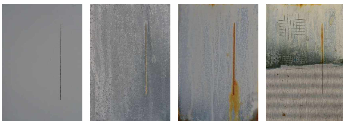
Nátěrové filmy s obsahem ZnFe 2 O 4 /PANI OKP=3 % před expozicí, po 120 hodinové expozici, po 1848 hodinové expozici, ocelový panel po odstranění nátěrového filmu
