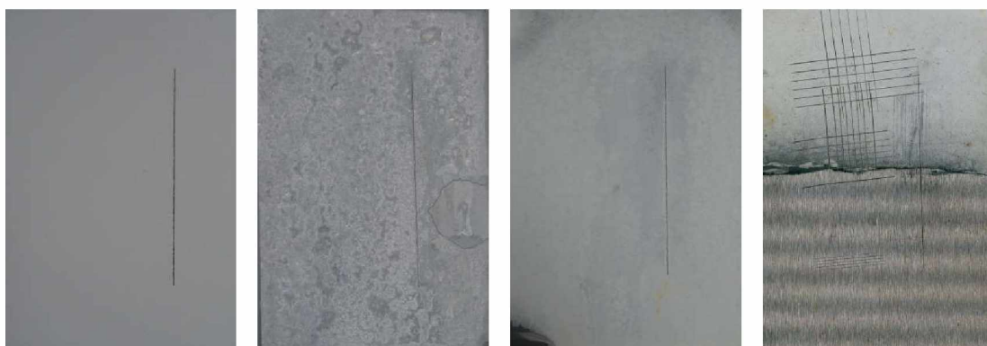
Nátěrové filmy s obsahem \text{MoS}_2/\text{PPY OKP}=1\% před expozicí, po 120 hodinové expozici, po 1848 hodinové expozici, ocelový panel po odstranění nátěrového filmu
