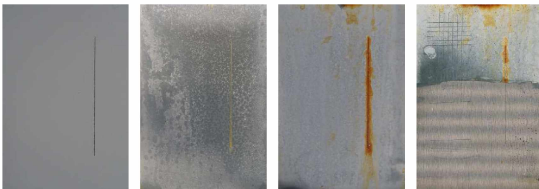
Nátěrové filmy s obsahem Zn OKP=63% po 120 hodinové expozici, po 1848 hodinové expozici, ocelový panel po odstranění nátěrového filmu
