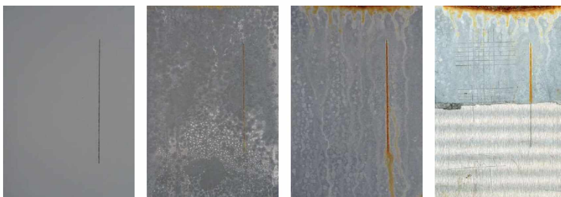
Nátěrové filmy s obsahem Litopon/PANI OKP=10 % před expozicí, po 120 hodinové expozici, po 1848 hodinové expozici, ocelový panel po odstranění nátěrového filmu
