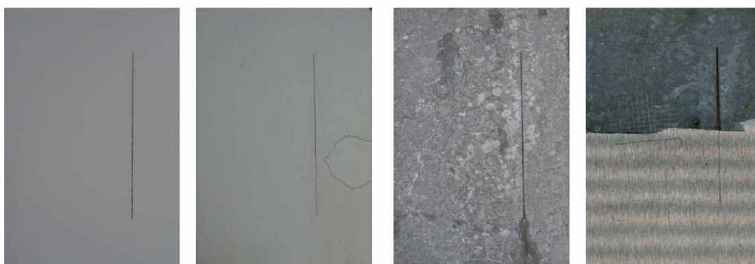
Nátěrové filmy s obsahem \text{MoS}_2/\text{PANI OKP}=10\% před expozicí, po 120 hodinové expozici, po 1848 hodinové expozici, ocelový panel po odstranění nátěrového filmu
