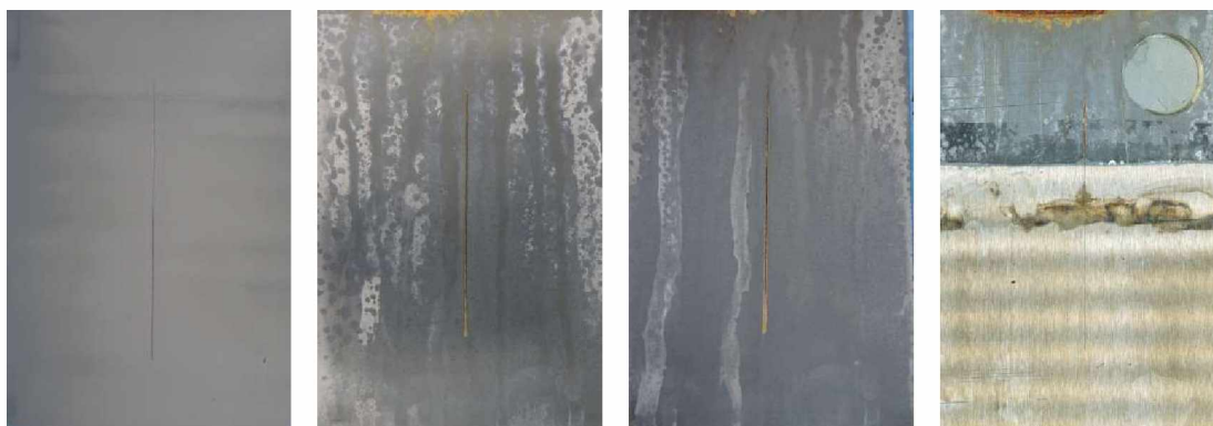
Nátěrové filmy s obsahem WS2 OKP= 10% před expozicí, po 120 hodinové expozici, po 600 hodinové expozici, ocelový panel po odstranění nátěrového filmu
