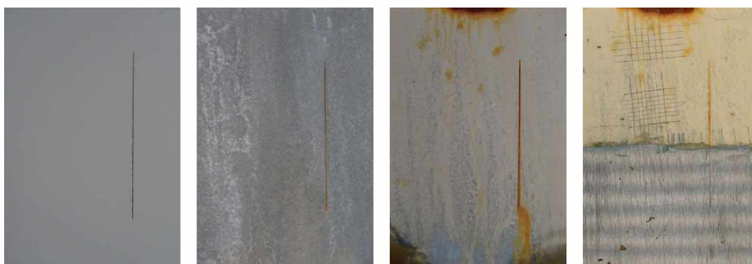
Nátěrové filmy s obsahem \text{ZnFe}_2\text{O}_4 /PPY OKP=5 % před expozicí, po 120 hodinové expozici, po 1848 hodinové expozici, ocelový panel po odstranění nátěrového filmu
