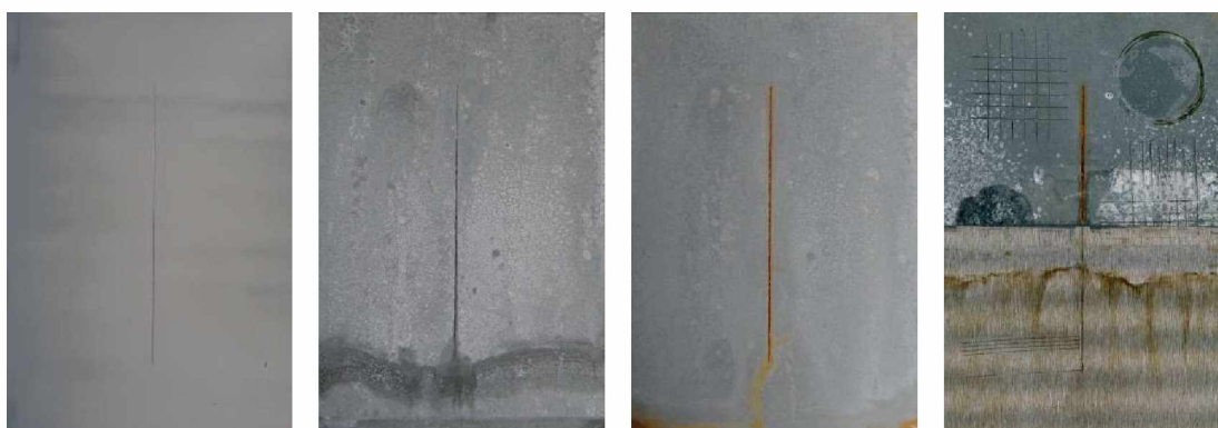
Nátěrové filmy s obsahem WS2/PANI OKP= 10% před expozicí, po 120 hodinové expozici, po 600 hodinové expozici, ocelový panel po odstranění nátěrového filmu
