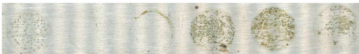
Po expozici 720 hodinách, po odstranění nátěru
