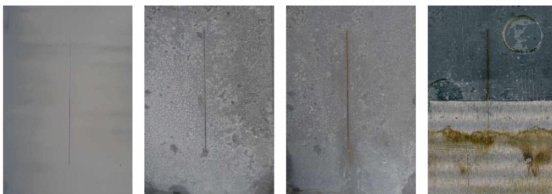
Nátěrové filmy s obsahem MoS 2 /PANI OKP= 10% před expozicí, po 120 hodinové expozici, po 600 hodinové expozici, ocelový panel po odstranění nátěrového filmu
