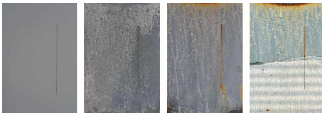
Nátěrové filmy s obsahem ZnFe 2 O 4 /PANI OKP=10 % před expozicí, po 120 hodinové expozici, po 1848 hodinové expozici, ocelový panel po odstranění nátěrového filmu
