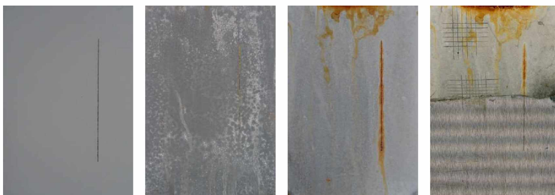
Nátěrové filmy s obsahem ZnS/PPY OKP=5 % před expozicí, po 120 hodinové expozici, po 1848 hodinové expozici, ocelový panel po odstranění nátěrového filmu
