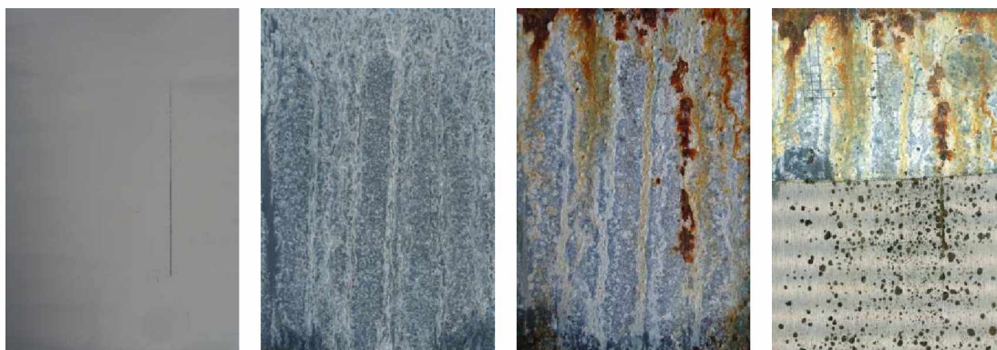
Nátěrové filmy s obsahem ZnFe 2 O 4 /PANI OKP=1% před expozicí, po 120 hodinové expozici, 1056 hodinové expozici a ocelový panel po odstranění nátěrového filmu
