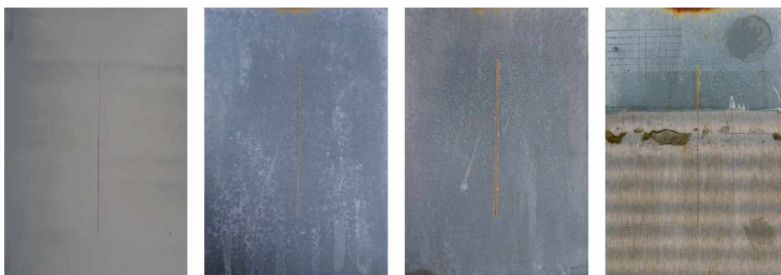
Nátěrové filmy s obsahem ZnS/PPY OKP= 1% před expozicí, po 120 hodinové expozici, po 600 hodinové expozici, ocelový panel po odstranění nátěrového filmu
