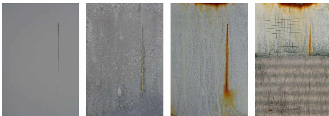
Nátěrové filmy s obsahem ZnFe 2 O 4 /PANI OKP=1 % před expozicí, po 120 hodinové expozici, po 1848 hodinové expozici, ocelový panel po odstranění nátěrového filmu
