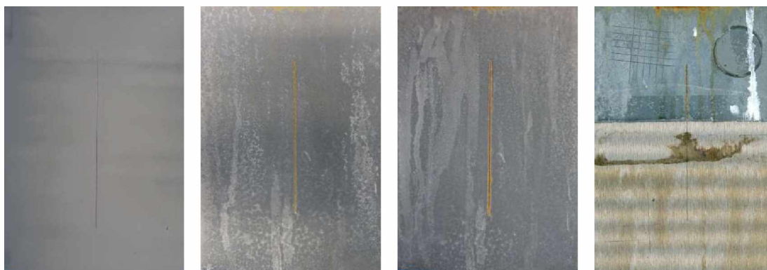
Nátěrové filmy s obsahem ZnFe_2O_4 /PPY OKP= 3% před expozicí, po 120 hodinové expozici, po 600 hodinové expozici, ocelový panel po odstranění nátěrového filmu
