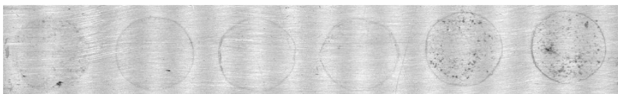
Po expozici 720 hodin, po odstranění nátěru
