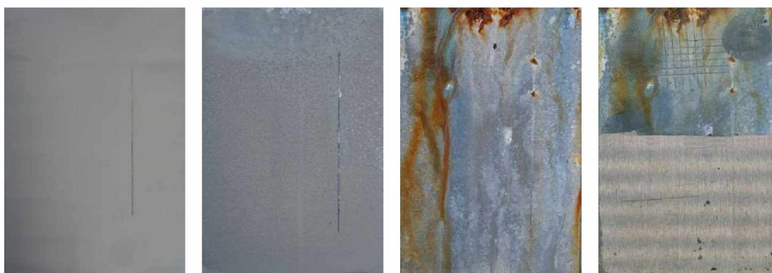
Nátěrové filmy s obsahem Litopon/PANI OKP=5% před expozicí, po 120 hodinové expozici, 1056 hodinové expozici a ocelový panel po odstranění nátěrového filmu
