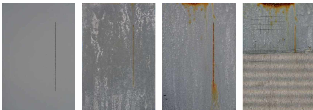
Nátěrové filmy s obsahem ZnS/PANI OKP=10 % před expozicí, po 120 hodinové expozici, po 1848 hodinové expozici, ocelový panel po odstranění nátěrového filmu
