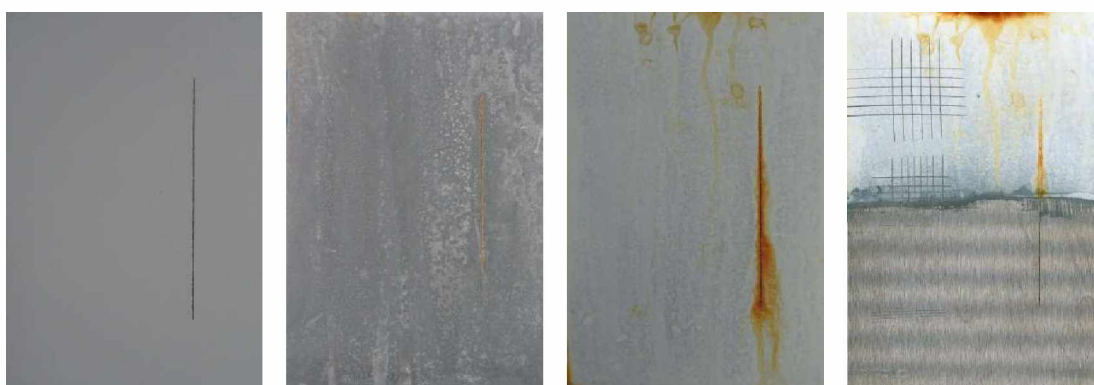
Nátěrové filmy s obsahem ZnS OKP=5 % před expozicí, po 120 hodinové expozici, po 1848 hodinové expozici, ocelový panel po odstranění nátěrového filmu
