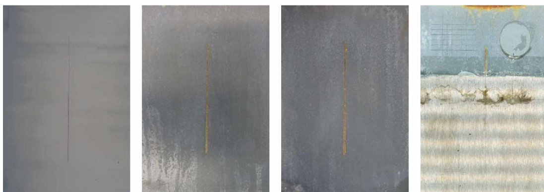
Nátěrové filmy s obsahem MoS2 OKP= 5% před expozicí, po 120 hodinové expozici, po 600 hodinové expozici, ocelový panel po odstranění nátěrového filmu
