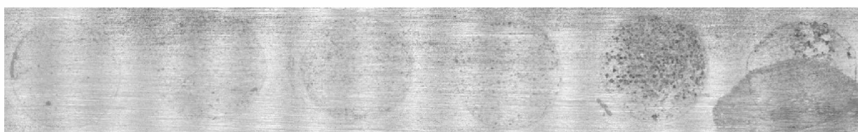
Po expozici 720 hodin, po odstranění nátěru
