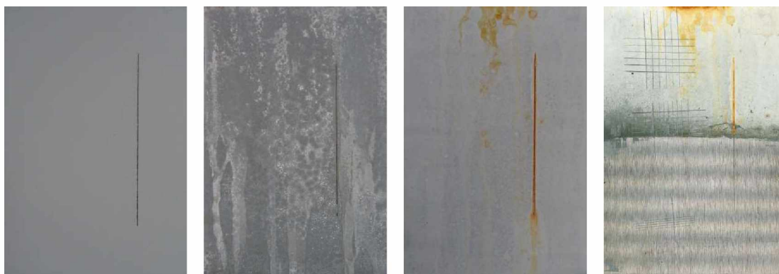
Nátěrové filmy s obsahem ZnS/PPY OKP=3 % před expozicí, po 120 hodinové expozici, po 1848 hodinové expozici, ocelový panel po odstranění nátěrového filmu
