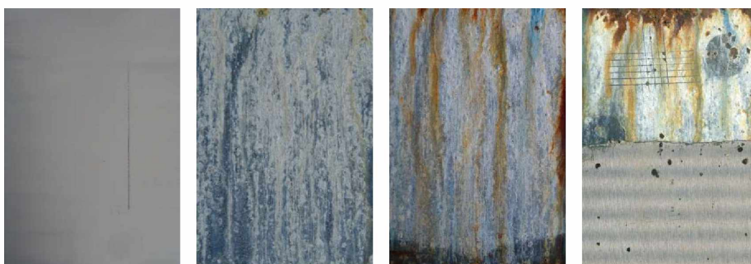
Nátěrové filmy s obsahem Litopon/PPY OKP=10% před expozicí, po 120 hodinové expozici, 1056 hodinové expozici a ocelový panel po odstranění nátěrového filmu
