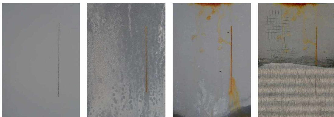
Nátěrové filmy s obsahem WS_2 OKP=3 % před expozicí, po 120 hodinové expozici, po 1848 hodinové expozici, ocelový panel po odstranění nátěrového filmu
