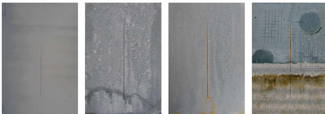
Nátěrové filmy s obsahem WS2/PANI OKP= 5% před expozicí, po 120 hodinové expozici, po 600 hodinové expozici, ocelový panel po odstranění nátěrového filmu
