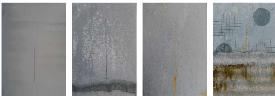
Nátěrové filmy s obsahem WS2/PANI OKP= 3% před expozicí, po 120 hodinové expozici, po 600 hodinové expozici, ocelový panel po odstranění nátěrového filmu
