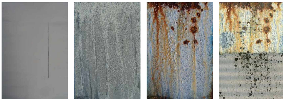
Nátěrové filmy s obsahem ZnFe_2O_4/PPY OKP=3% před expozicí, po 120 hodinové expozici, 1056 hodinové expozici a ocelový panel po odstranění nátěrového filmu
