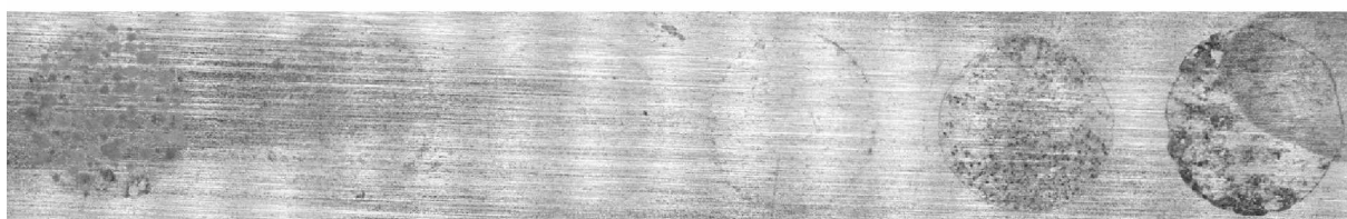
Po expozici 720 hodin, po odstranění nátěrového filmu
