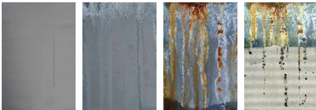
Nátěrové filmy s obsahem ZnS/PANI OKP=10% před expozicí, po 120 hodinové expozici, 1056 hodinové expozici a ocelový panel po odstranění nátěrového filmu
