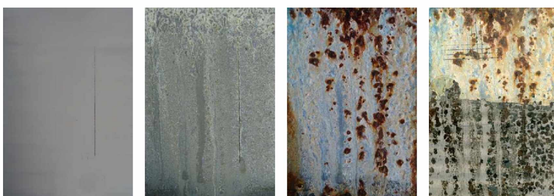
Nátěrové filmy s obsahem ZnFe_2O_4/PPY OKP=10% před expozicí, po 120 hodinové expozici, 1056 hodinové expozici a ocelový panel po odstranění nátěrového filmu
