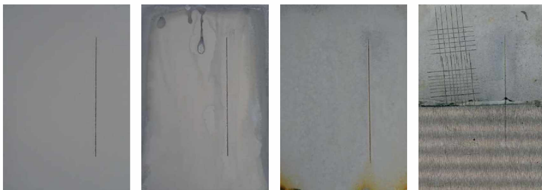
Nátěrové filmy s obsahem MoS 2 /PPY OKP=3 % před expozicí, po 120 hodinové expozici, po 1848 hodinové expozici, ocelový panel po odstranění nátěrového filmu
