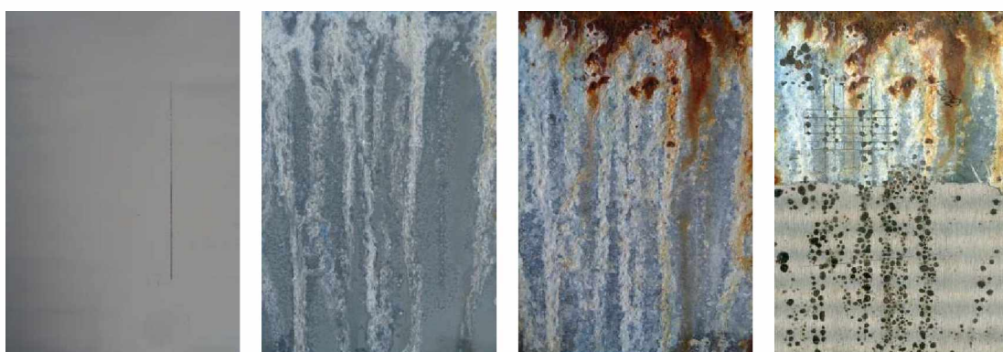
Nátěrové filmy s obsahem ZnS/PANI OKP=3% před expozicí, po 120 hodinové expozici, 1056 hodinové expozici a ocelový panel po odstranění nátěrového filmu
