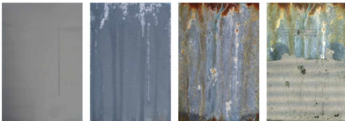
Nátěrové filmy s obsahem ZnS/PPY OKP=3% před expozicí, po 120 hodinové expozici, 1056 hodinové expozici a ocelový panel po odstranění nátěrového filmu
