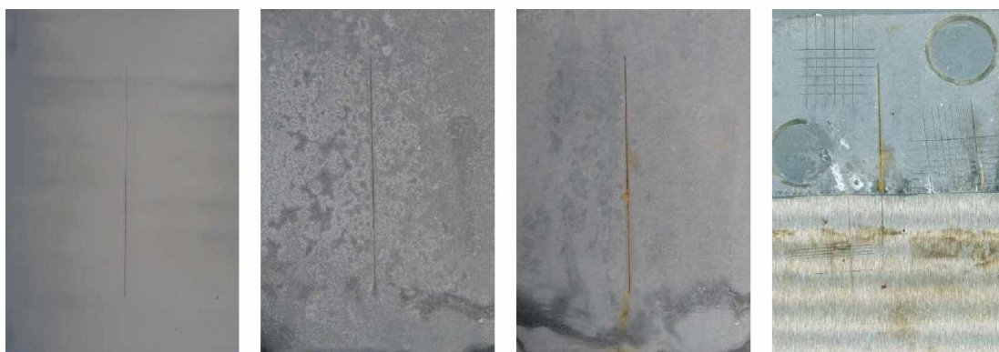
Nátěrové filmy s obsahem MoS 2 /PANI OKP= 3% před expozicí, po 120 hodinové expozici, po 600 hodinové expozici, ocelový panel po odstranění nátěrového filmu
