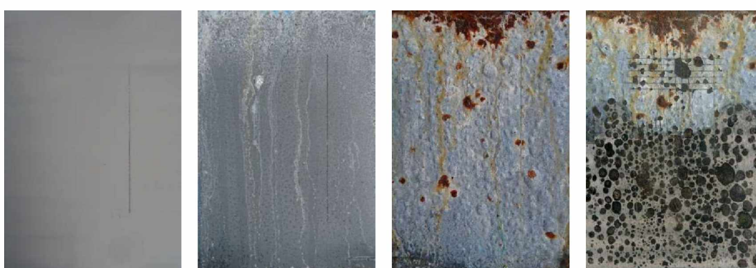
Nátěrové filmy s obsahem MoS 2 OKP=5% před expozicí, po 120 hodinové expozici, 1056 hodinové expozici a ocelový panel po odstranění nátěrového filmu
