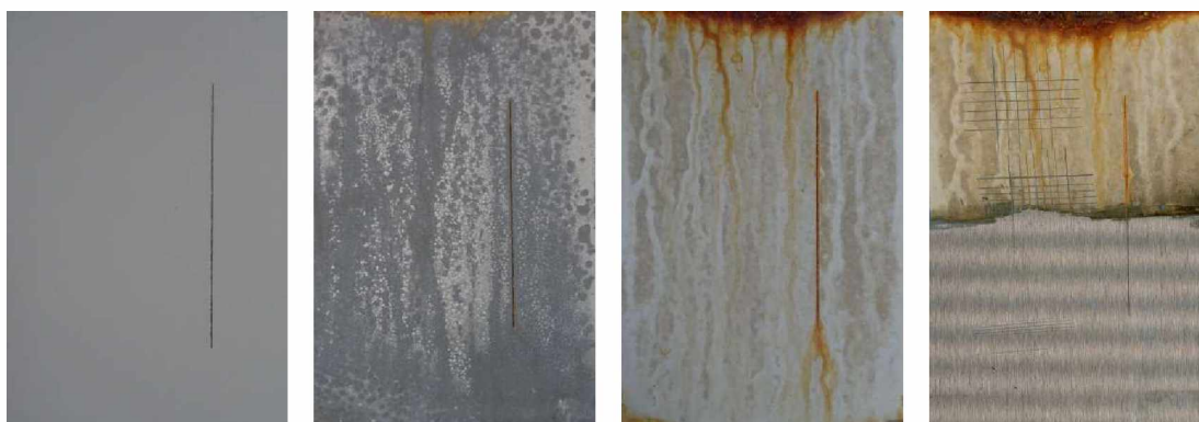
Nátěrové filmy s obsahem Litopon/PPY OKP=10 % před expozicí, po 120 hodinové expozici, po 1848 hodinové expozici, ocelový panel po odstranění nátěrového filmu
