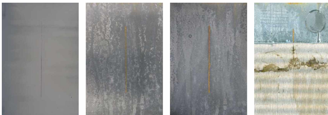
Nátěrové filmy s obsahem ZnFe_2O_4 /PANI OKP= 5% před expozicí, po 120 hodinové expozici, po 600 hodinové expozici, ocelový panel po odstranění nátěrového filmu
