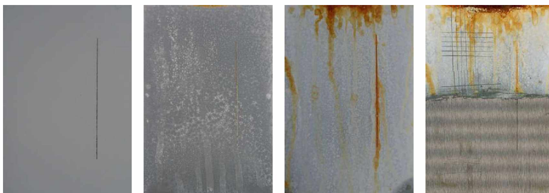
Nátěrové filmy s obsahem Litoponu OKP=5 % před expozicí, po 120 hodinové expozici, po 1848 hodinové expozici, ocelový panel po odstranění nátěrového filmu
