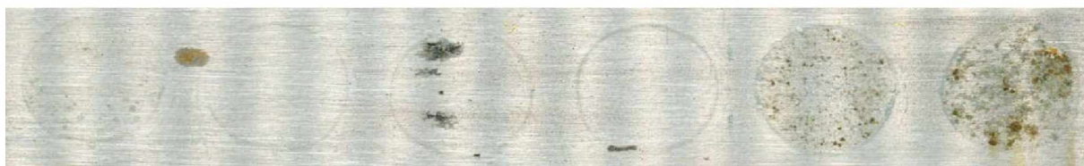
Po expozici 720 hodinách, po odstranění nátěru
