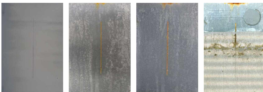
Nátěrové filmy s obsahem ZnFe_2O_4 /PANI OKP= 1% před expozicí, po 120 hodinové expozici, po 600 hodinové expozici, ocelový panel po odstranění nátěrového filmu
