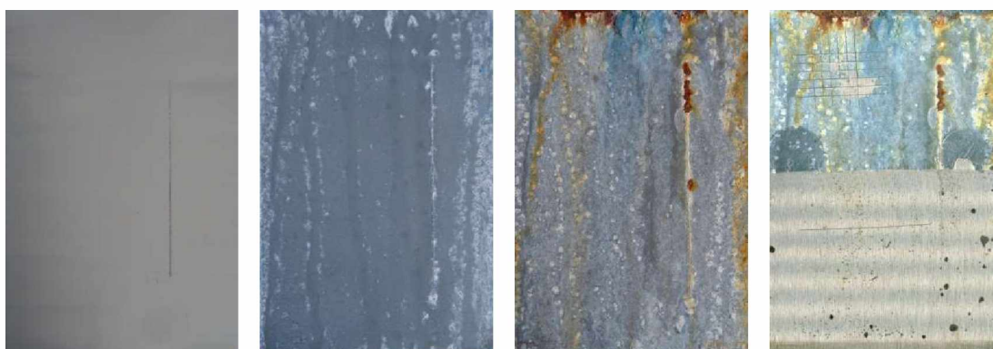
Nátěrové filmy s obsahem Zn OKP= 67% před expozicí, po 120 hodinové expozici, 1056 hodinové expozici a ocelový panel po odstranění nátěrového filmu
