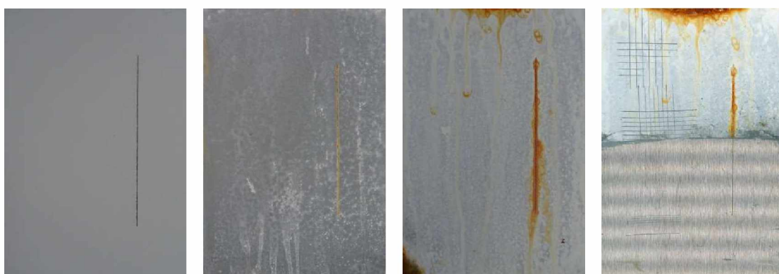
Nátěrové filmy s obsahem ZnS/PANI OKP=3 % před expozicí, po 120 hodinové expozici, po 1848 hodinové expozici, ocelový panel po odstranění nátěrového filmu
