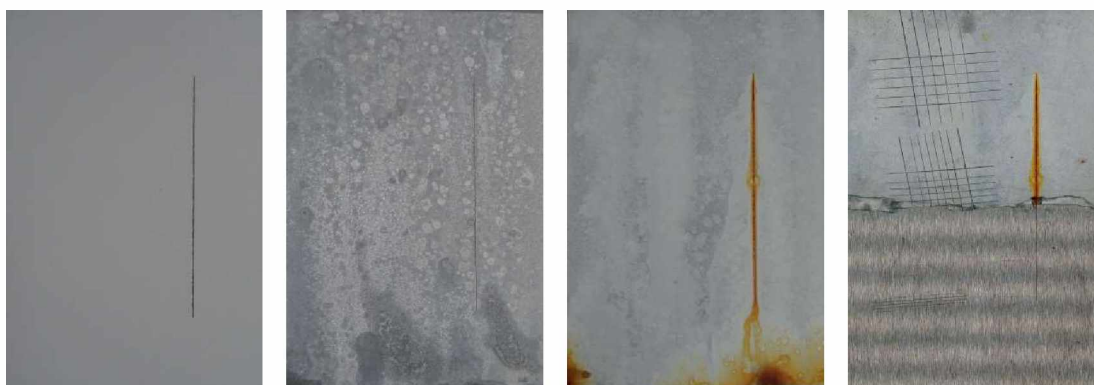
Nátěrové filmy s obsahem WS_2/PANI OKP=3 % před expozicí, po 120 hodinové expozici, po 1848 hodinové expozici, ocelový panel po odstranění nátěrového filmu
