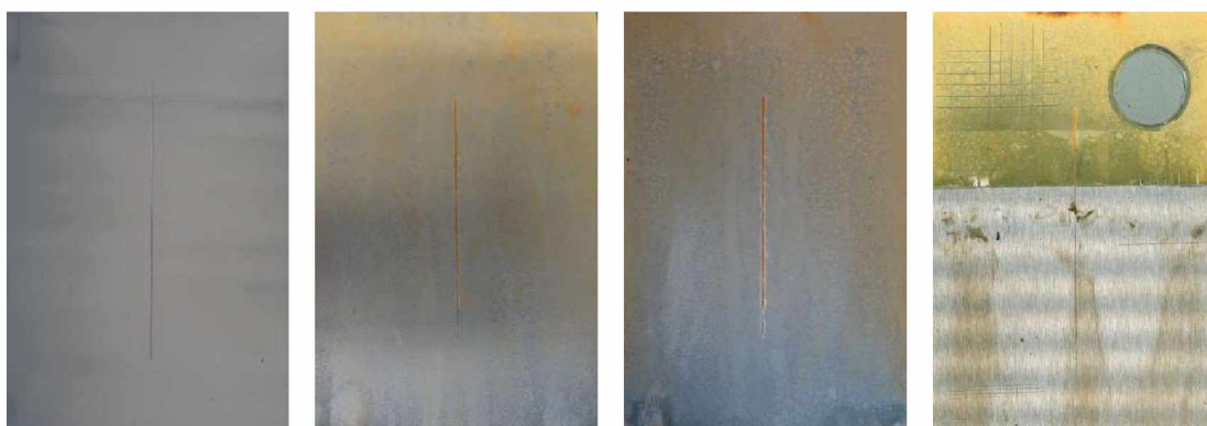
Nátěrové filmy s obsahem ZnFe_2O_4 OKP= 5% před expozicí, po 120 hodinové expozici, po 600 hodinové expozici, ocelový panel po odstranění nátěrového filmu
