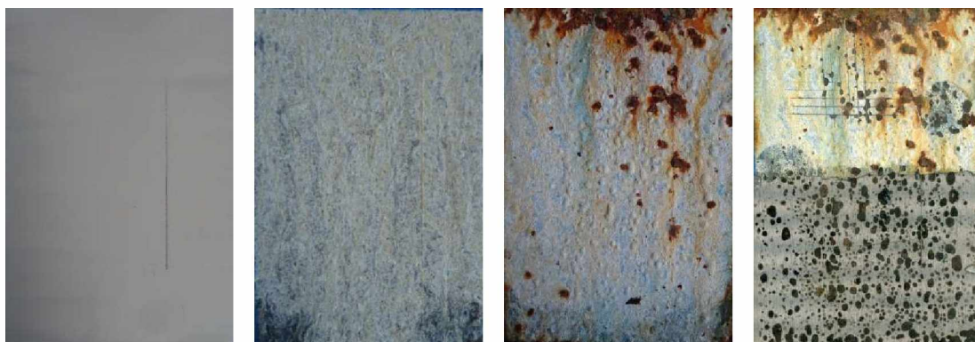
Nátěrové filmy s obsahem ZnFe_2O_4 OKP=3% před expozicí, po 120 hodinové expozici, 1056 hodinové expozici a ocelový panel po odstranění nátěrového filmu
