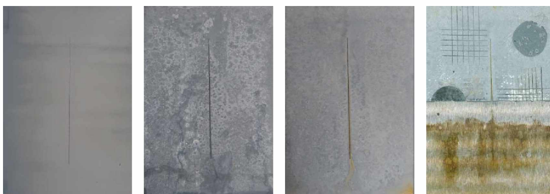
Nátěrové filmy s obsahem WS 2 /PPY OKP= 10% před expozicí, po 120 hodinové expozici, po 600 hodinové expozici, ocelový panel po odstranění nátěrového filmu
