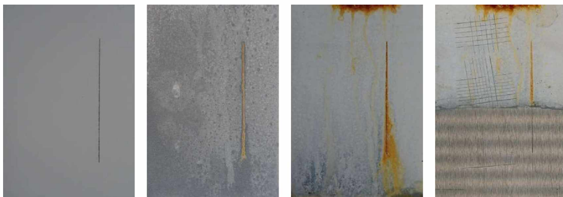
Nátěrové filmy s obsahem WS_2 OKP=1 % před expozicí, po 120 hodinové expozici, po 1848 hodinové expozici, ocelový panel po odstranění nátěrového filmu
