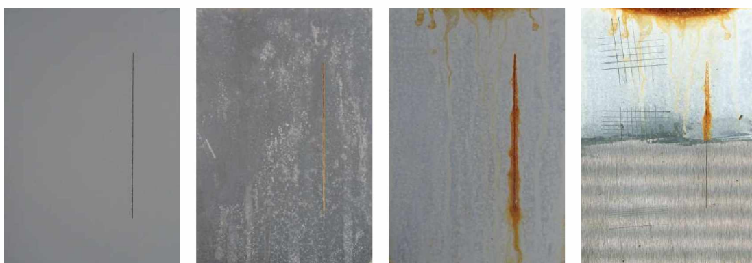
Nátěrové filmy s obsahem ZnS/PANI OKP=1 % před expozicí, po 120 hodinové expozici, po 1848 hodinové expozici, ocelový panel po odstranění nátěrového filmu
