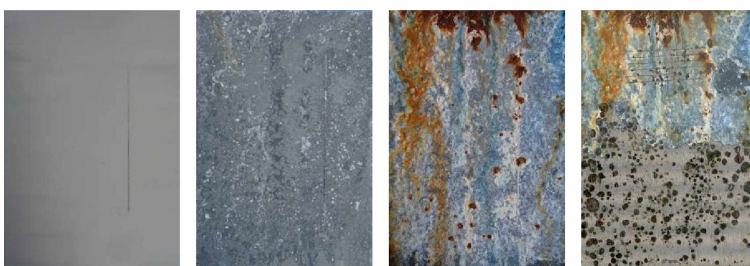
Nátěrové filmy s obsahem Litopon/PPY OKP=1% před expozicí, po 120 hodinové expozici, 1056 hodinové expozici a ocelový panel po odstranění nátěrového filmu
