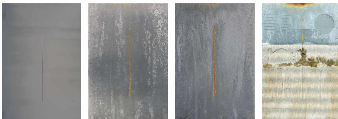
Nátěrové filmy s obsahem ZnFe_2O_4 /PANI OKP= 3% před expozicí, po 120 hodinové expozici, po 600 hodinové expozici, ocelový panel po odstranění nátěrového filmu
