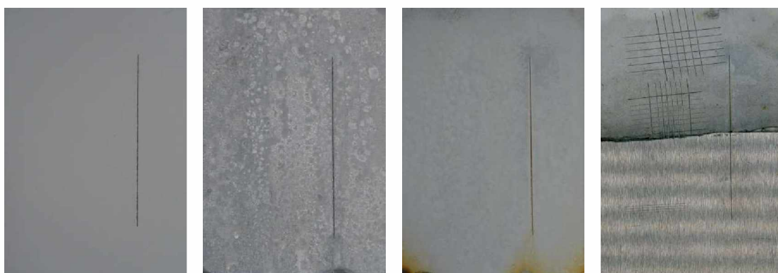
Nátěrové filmy s obsahem MoS 2 /PPY OKP=5 % před expozicí, po 120 hodinové expozici, po 1848 hodinové expozici, ocelový panel po odstranění nátěrového filmu
