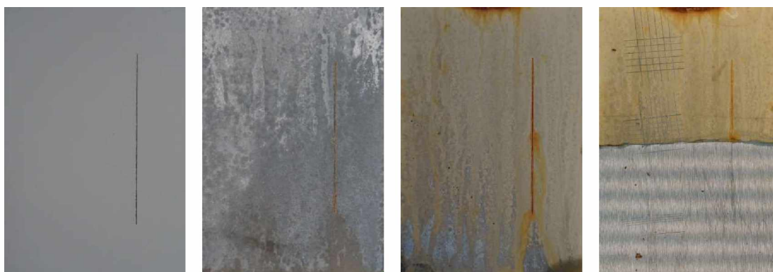
Nátěrové filmy s obsahem \text{ZnFe}_2\text{O}_4 /PPY OKP=10 % před expozicí, po 120 hodinové expozici, po 1848 hodinové expozici, ocelový panel po odstranění nátěrového filmu
