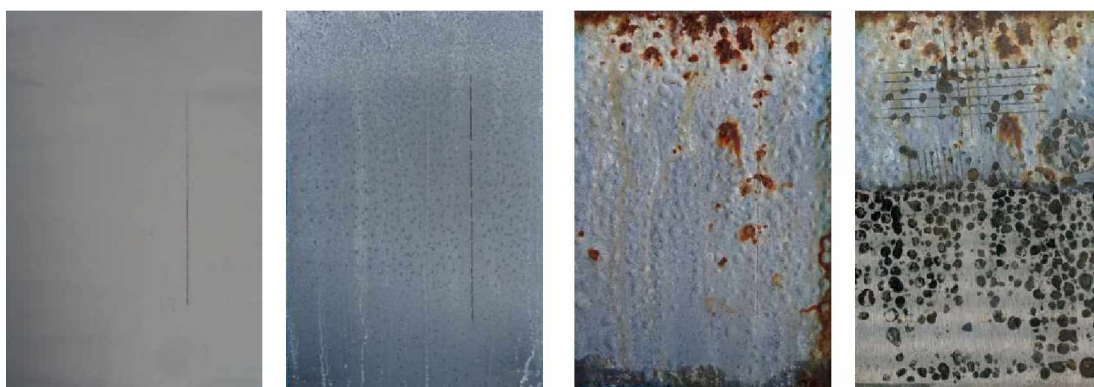
Nátěrové filmy s obsahem MoS 2 OKP=10% před expozicí, po 120 hodinové expozici, 1056 hodinové expozici a ocelový panel po odstranění nátěrového filmu
