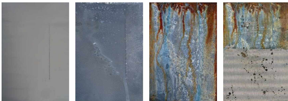
Nátěrové filmy s obsahem Litopon/PPY OKP=5% před expozicí, po 120 hodinové expozici, 1056 hodinové expozici a ocelový panel po odstranění nátěrového filmu
