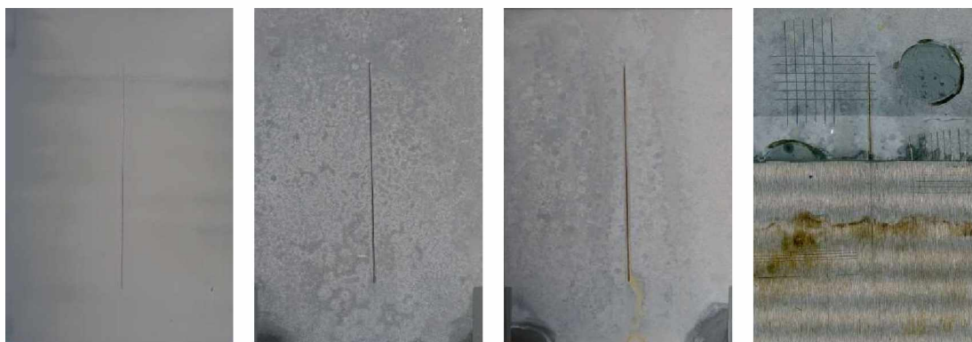
Nátěrové filmy s obsahem MoS 2 /PPY OKP= 3% před expozicí, po 120 hodinové expozici, po 600 hodinové expozici, ocelový panel po odstranění nátěrového filmu
