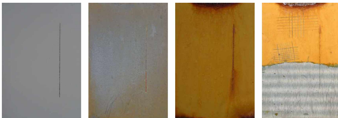
Nátěrové filmy s obsahem ZnFe 2 O 4 OKP=10 % před expozicí, po 120 hodinové expozici, po 1848 hodinové expozici, ocelový panel po odstranění nátěrového filmu
