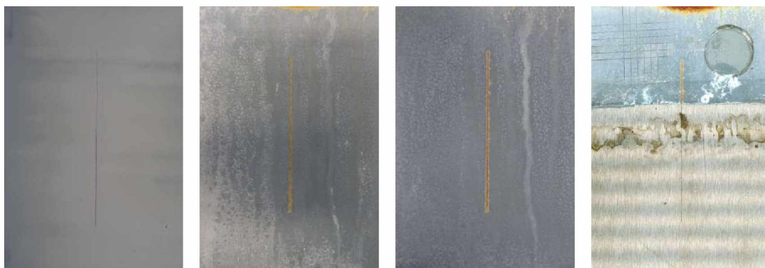
Nátěrové filmy s obsahem WS2 OKP= 1% před expozicí, po 120 hodinové expozici, po 600 hodinové expozici, ocelový panel po odstranění nátěrového filmu
