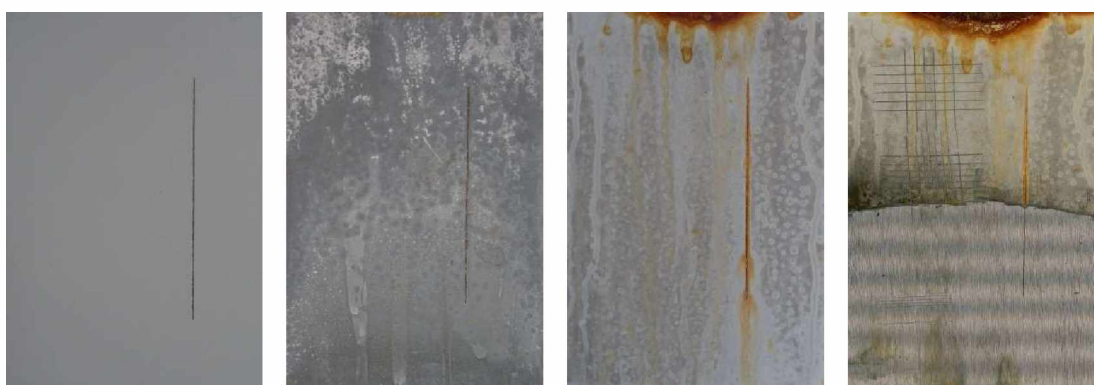
Nátěrové filmy s obsahem ZnS/PPY OKP=10 % před expozicí, po 120 hodinové expozici, po 1848 hodinové expozici, ocelový panel po odstranění nátěrového filmu
