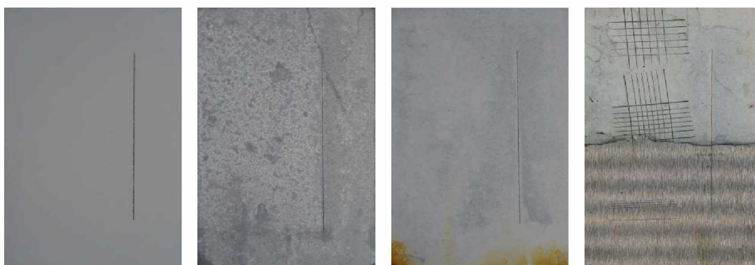
Nátěrové filmy s obsahem WS_2/PPY OKP=5 % před expozicí, po 120 hodinové expozici, po 1848 hodinové expozici, ocelový panel po odstranění nátěrového filmu
