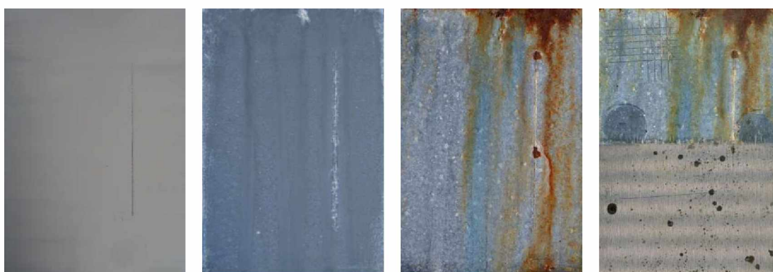
Nátěrové filmy s obsahem ZnS OKP= 5% před expozicí, po 120 hodinové expozici, 1056 hodinové expozici a ocelový panel po odstranění nátěrového filmu
