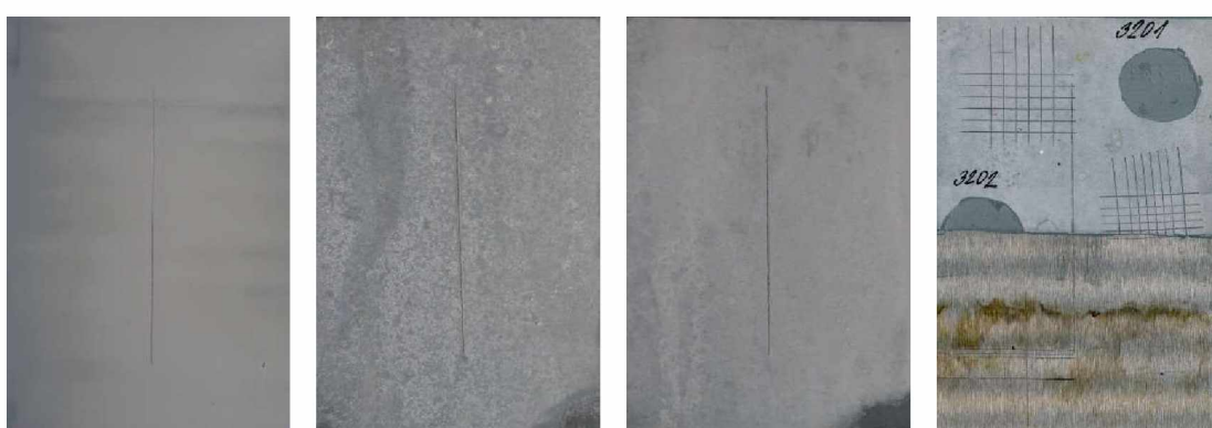
Nátěrové filmy s obsahem MoS 2 /PANI OKP= 1% před expozicí, po 120 hodinové expozici, po 600 hodinové expozici, ocelový panel po odstranění nátěrového filmu
