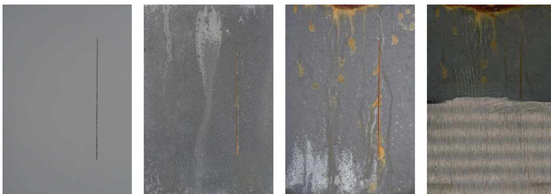
Nátěrové filmy s obsahem MoS 2 OKP=10 % před expozicí, po 120 hodinové expozici, po 1848 hodinové expozici, ocelový panel po odstranění nátěrového filmu
