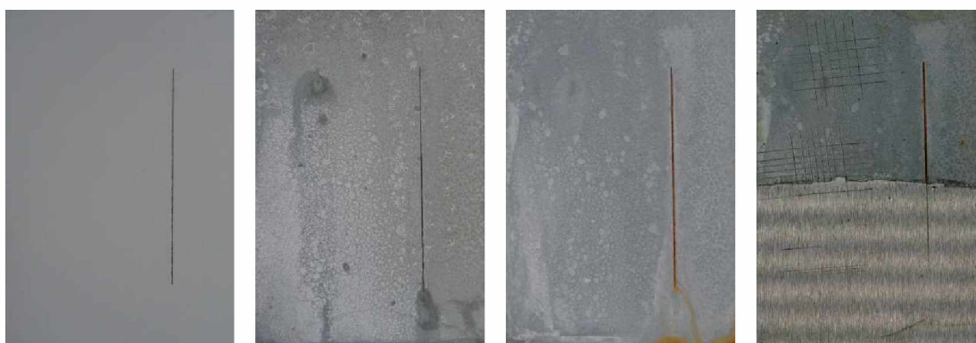
Nátěrové filmy s obsahem WS_2/PANI OKP=10 % před expozicí, po 120 hodinové expozici, po 1848 hodinové expozici, ocelový panel po odstranění nátěrového filmu
