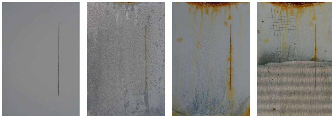
Nátěrové filmy s obsahem MoS 2 OKP=1 % před expozicí, po 120 hodinové expozici, po 1848 hodinové expozici, ocelový panel po odstranění nátěrového filmu
