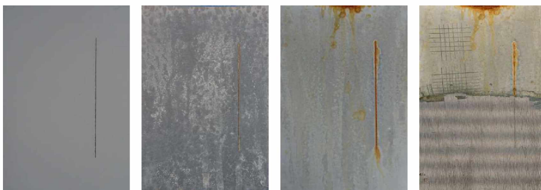
Nátěrové filmy s obsahem Litopon/PPY OKP=5 % před expozicí, po 120 hodinové expozici, po 1848 hodinové expozici, ocelový panel po odstranění nátěrového filmu
