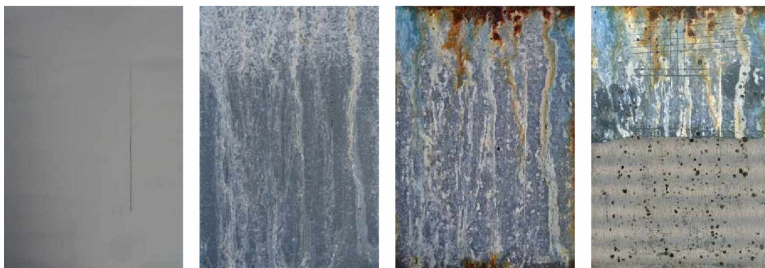
Nátěrové filmy s obsahem Litopon OKP=10% před expozicí, po 120 hodinové expozici, 1056 hodinové expozici a ocelový panel po odstranění nátěrového filmu
