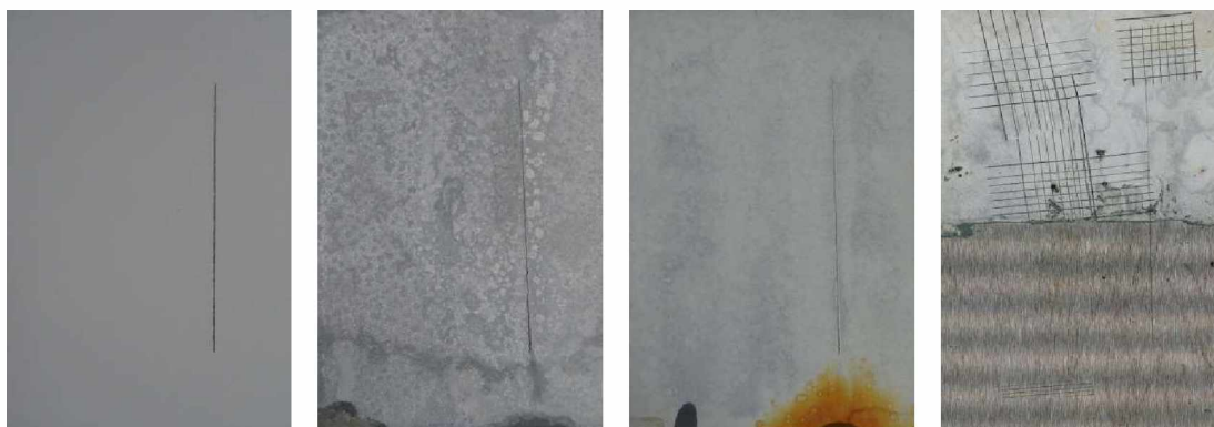
Nátěrové filmy s obsahem WS_2/PPY OKP=3 % před expozicí, po 120 hodinové expozici, po 1848 hodinové expozici, ocelový panel po odstranění nátěrového filmu
