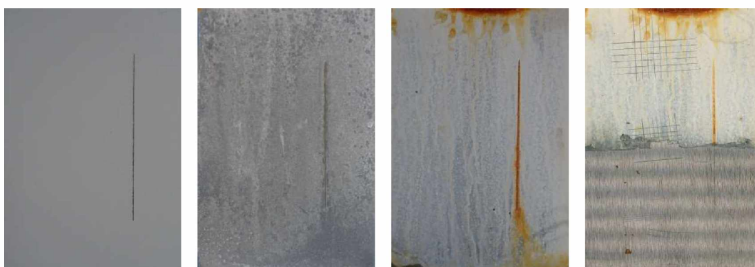
Nátěrové filmy s obsahem ZnFe 2 O 4 /PPY OKP=1 % před expozicí, po 120 hodinové expozici, po 1848 hodinové expozici, ocelový panel po odstranění nátěrového filmu
