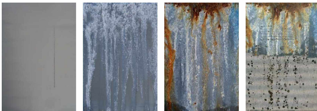
Nátěrové filmy s obsahem ZnS/PPY OKP=5% před expozicí, po 120 hodinové expozici, 1056 hodinové expozici a ocelový panel po odstranění nátěrového filmu
