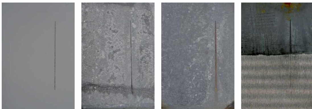
Nátěrové filmy s obsahem \text{MoS}_2/\text{PANI OKP}=5\% před expozicí, po 120 hodinové expozici, po 1848 hodinové expozici, ocelový panel po odstranění nátěrového filmu
