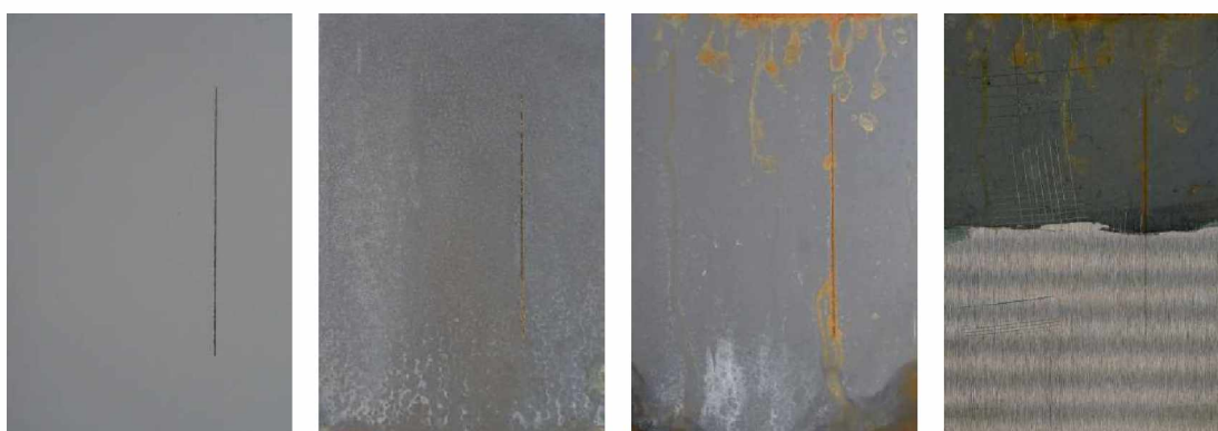
Nátěrové filmy s obsahem MoS 2 OKP=5 % před expozicí, po 120 hodinové expozici, po 1848 hodinové expozici, ocelový panel po odstranění nátěrového filmu
