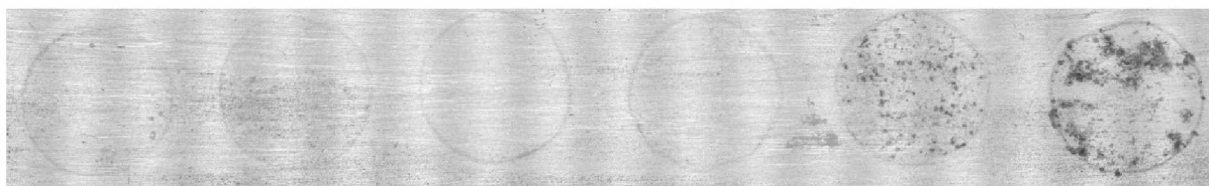
Po expozici 720 hodin, po odstranění nátěru
