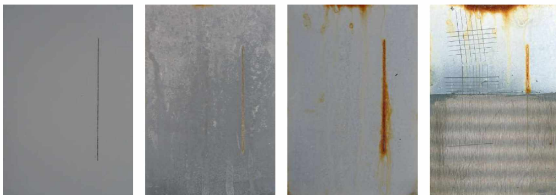
Nátěrové filmy s obsahem ZnS OKP=10 % před expozicí, po 120 hodinové expozici, po 1848 hodinové expozici, ocelový panel po odstranění nátěrového filmu
