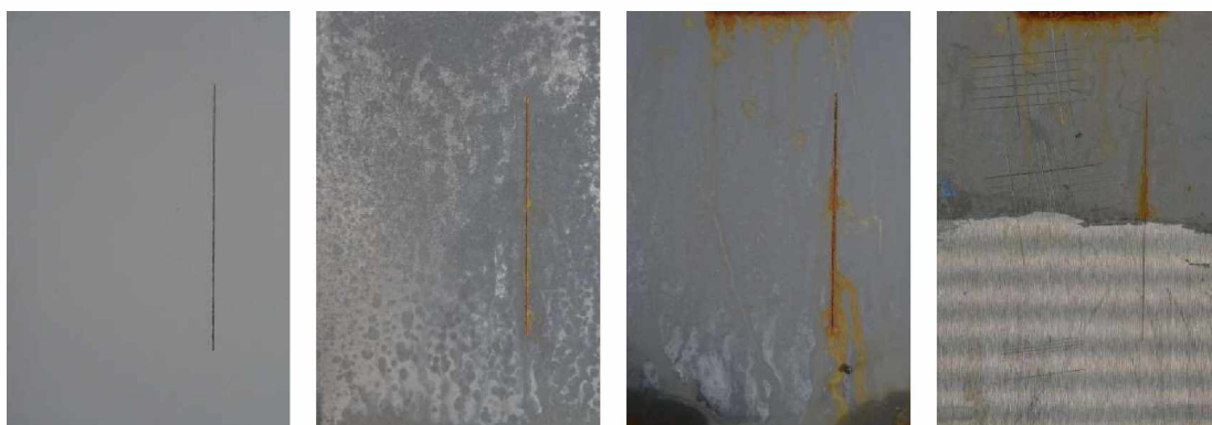
Nátěrové filmy s obsahem WS_2 OKP=5 % před expozicí, po 120 hodinové expozici, po 1848 hodinové expozici, ocelový panel po odstranění nátěrového filmu
