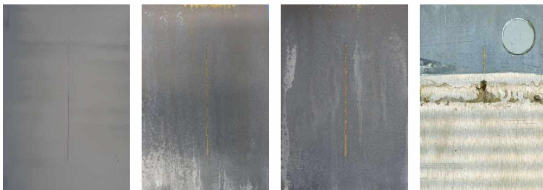
Nátěrové filmy s obsahem MoS 2 OKP= 10% před expozicí, po 120 hodinové expozici, po 600 hodinové expozici, ocelový panel po odstranění nátěrového filmu
