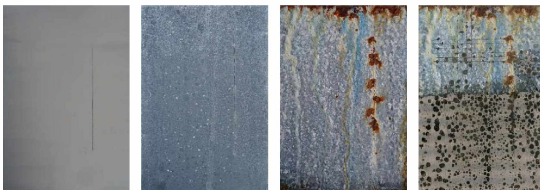
Nátěrové filmy s obsahem WS 2 OKP=1% před expozicí, po 120 hodinové expozici, 1056 hodinové expozici a ocelový panel po odstranění nátěrového filmu
