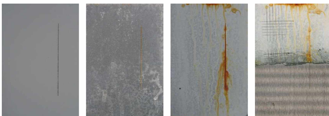
Nátěrové filmy s obsahem Litopon/PPY OKP=1 % před expozicí, po 120 hodinové expozici, po 1848 hodinové expozici, ocelový panel po odstranění nátěrového filmu
