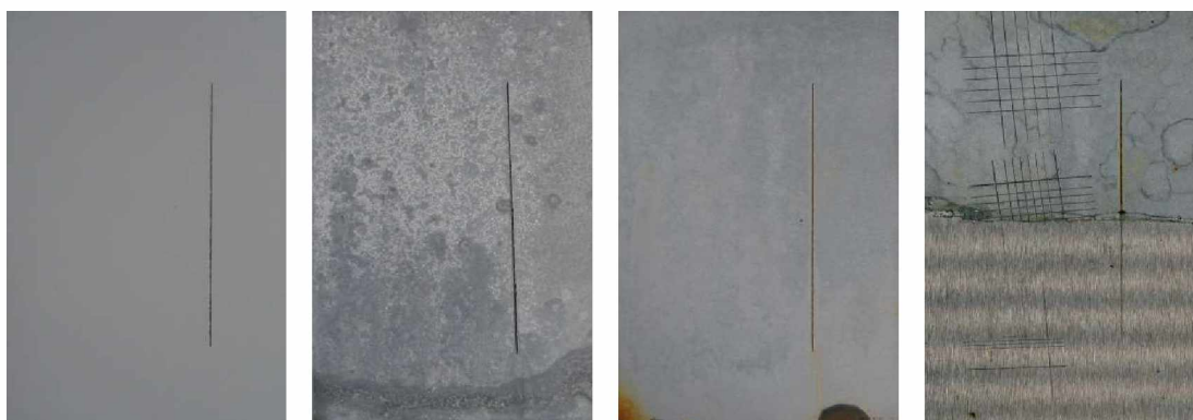
Nátěrové filmy s obsahem WS_2/PPY OKP=10 % před expozicí, po 120 hodinové expozici, po 1848 hodinové expozici, ocelový panel po odstranění nátěrového filmu
