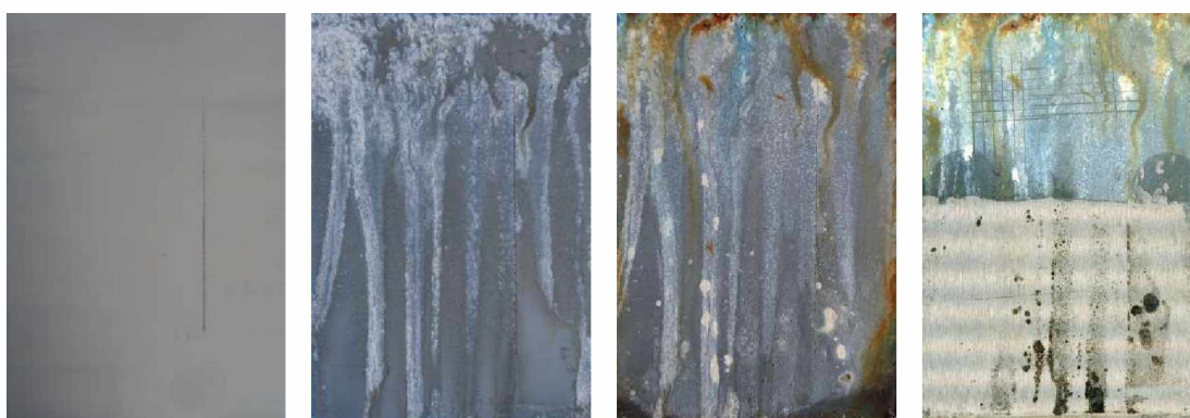
Nátěrové filmy s obsahem ZnS/PPY OKP=10% před expozicí, po 120 hodinové expozici, 1056 hodinové expozici a ocelový panel po odstranění nátěrového filmu
