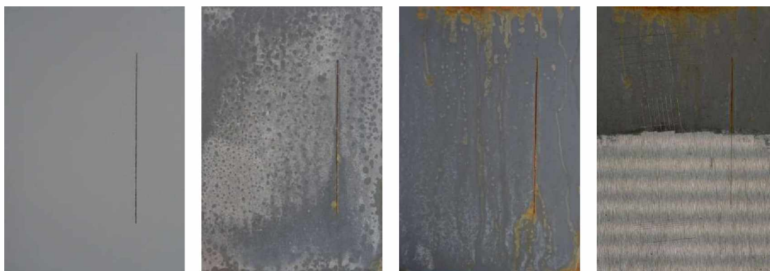
Nátěrové filmy s obsahem WS_2 OKP=10 % před expozicí, po 120 hodinové expozici, po 1848 hodinové expozici, ocelový panel po odstranění nátěrového filmu
