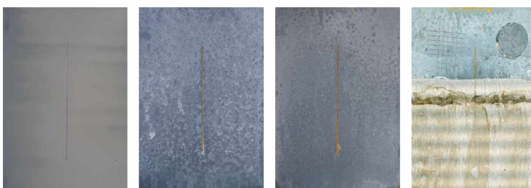
Nátěrové filmy s obsahem Litopon/PANI OKP= 10% před expozicí, po 120 hodinové expozici, po 600 hodinové expozici, ocelový panel po odstranění nátěrového filmu
