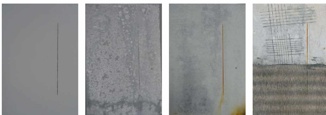
Nátěrové filmy s obsahem WS_2/PPY OKP=1 % před expozicí, po 120 hodinové expozici, po 1848 hodinové expozici, ocelový panel po odstranění nátěrového filmu
