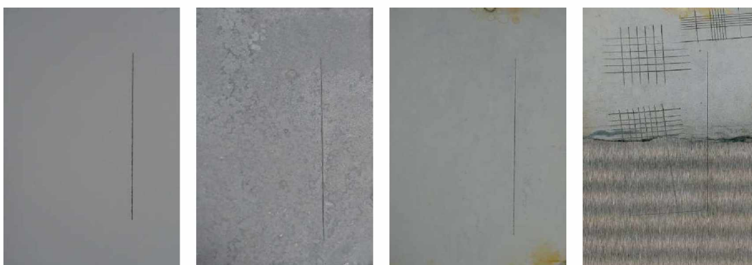
Nátěrové filmy s obsahem MoS 2 /PANI OKP=1 % před expozicí, po 120 hodinové expozici, po 1848 hodinové expozici, ocelový panel po odstranění nátěrového filmu
