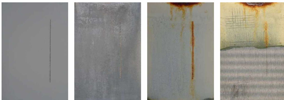
Nátěrové filmy s obsahem ZnFe 2 O 4 OKP=1 % před expozicí, po 120 hodinové expozici, po 1848 hodinové expozici, ocelový panel po odstranění nátěrového filmu
