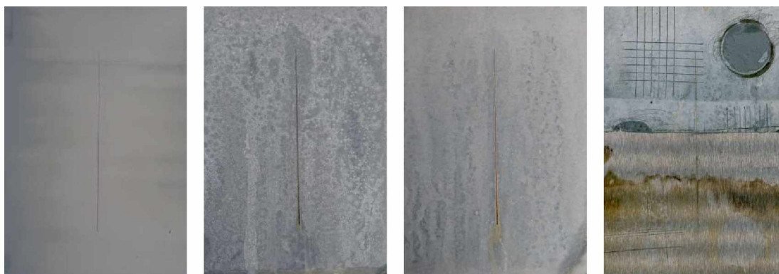
Nátěrové filmy s obsahem WS 2 /PPY OKP= 3% před expozicí, po 120 hodinové expozici, po 600 hodinové expozici, ocelový panel po odstranění nátěrového filmu
