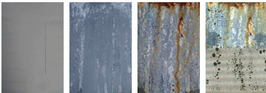
Nátěrové filmy s obsahem ZnS/PANI OKP=1% před expozicí, po 120 hodinové expozici, 1056 hodinové expozici a ocelový panel po odstranění nátěrového filmu
