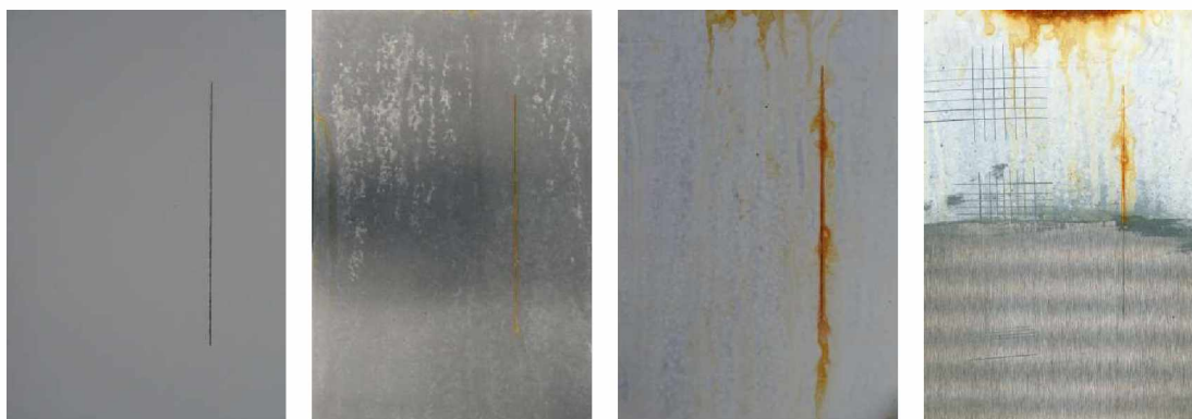
Nátěrové filmy s obsahem ZnS OKP=1% před expozicí, po 120 hodinové expozici, po 1848 hodinové expozici, ocelový panel po odstranění nátěrového filmu
