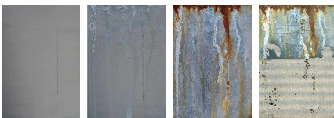
Nátěrové filmy s obsahem Litopon/PANI OKP=3% před expozicí, po 120 hodinové expozici, 1056 hodinové expozici a ocelový panel po odstranění nátěrového filmu
