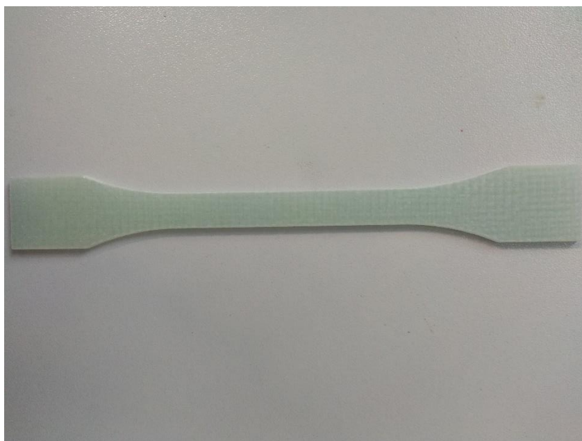
Obrázek 34 Vzorek ve tvaru "psi kosti" pro měření pevnosti v tahu
