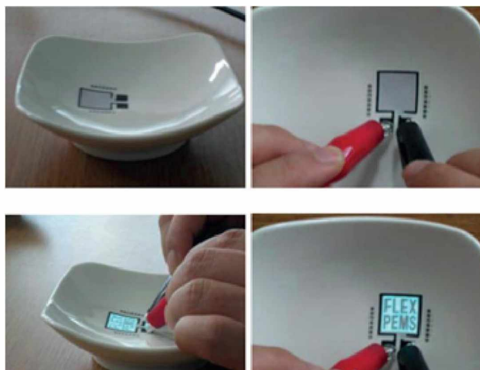
Obrázek 3 Elektroluminiscenční displej tištěný tamponovým tiskem na nádobu s poloměrem zakřivení 80 mm při 200 V, 1 kHz s luminancí 180 cd/m 2 [14].
