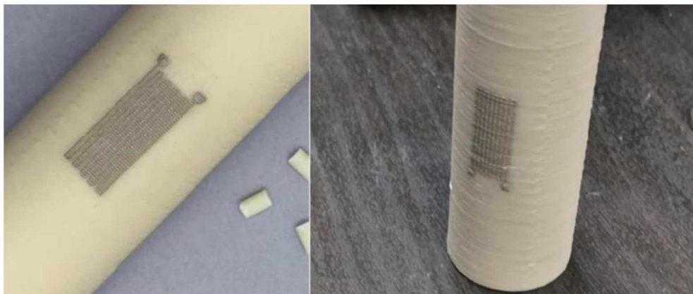
Obrázek 18 Tenzometr konformně vytištěný na povrch PAPC válce [47].
