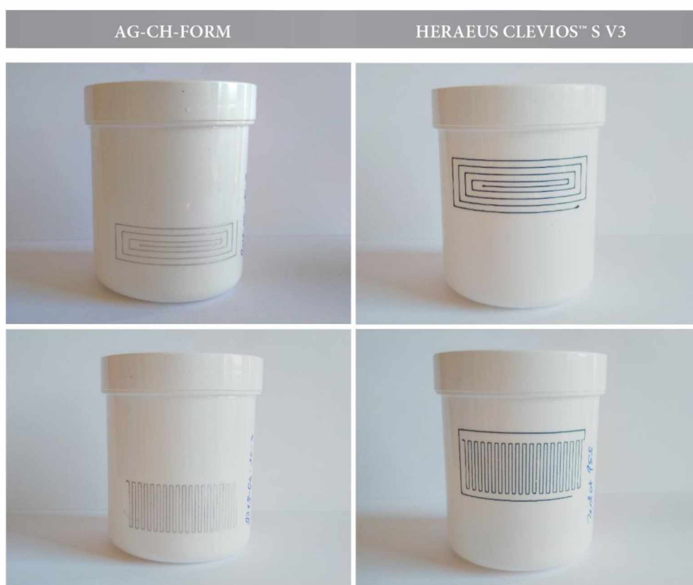
Obrázek 36 Náhled vytištěných meandrů na polypropylenovou dózu formulacemi na bázi mikročástic stříbra a disperze polymeru PEDOT:PSS. Výška dózy je 67,2 mm a průměr 52,8 mm.
