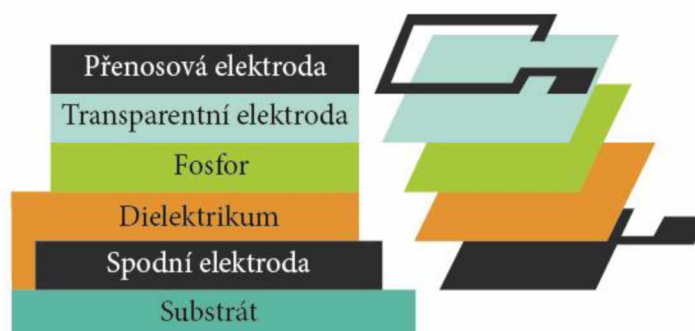
Obrázek 2 Schématické znázornění vrstev elektrochemického displeje, tištěného do nádoby níže zobrazené [14].
