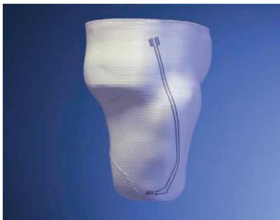
Obrázek 16 Příklad využití technologie Aerosol Jet a mikrodispensing při tisku vodivých struktur (tenzometr) na neplanární povrch. Termoplastická protéza z materiálu PLA byla vytištěná na FDM 3D tiskárně [45].
