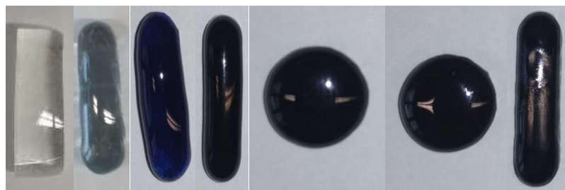
Obr. 52 . Snímky vzorků skel řady (100-x)[0.5\text{BaO}-0.1\text{B}_2\text{O}_3-0.4\text{P}_2\text{O}_5]-x\text{WO}_3 v pořadí od x=0 do x=60 .
