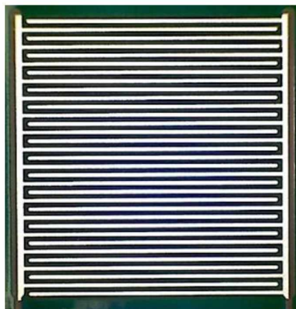
Obrázek 38 - IDE v průběhu detekce. a) čistá IDE, b) IDE s čerstvě nanesenou vrstvou CuO, c) IDE po expozici H 2 S, d) IDE po očištění vrstvy.
