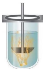
Obrázek 6: Schéma pádelkového uspořádání disolučního testu, převzato z [55]
