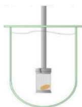
Obrázek 7: Schéma košíčkového uspořádání disolučního testu, převzato z [56]
