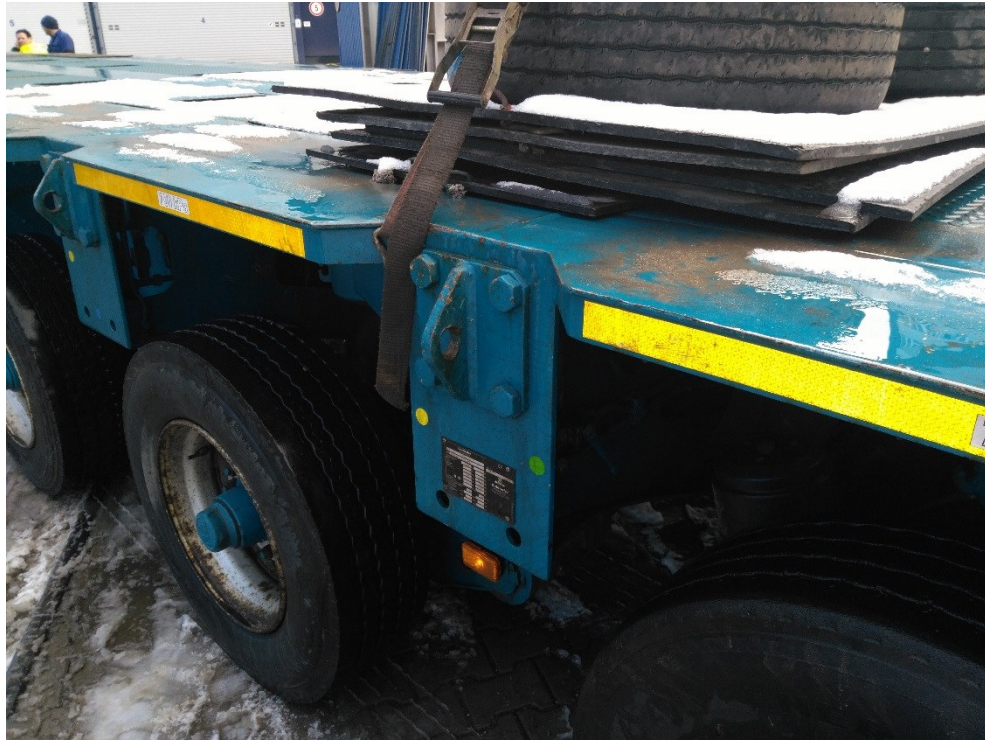
Obrázek 25 Vázací oko THP modulu Goldhofer
