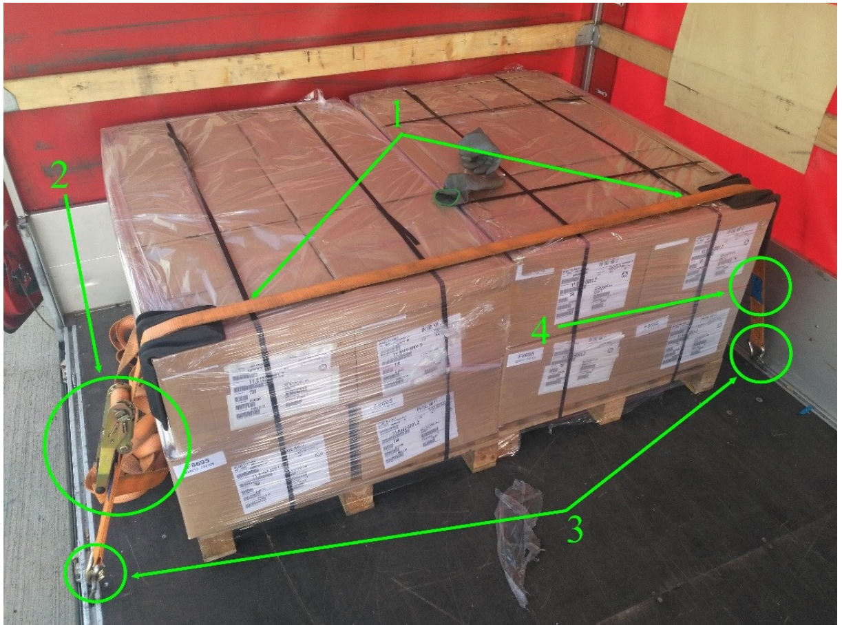
Obrázek 26 Ukázka použití vázacího popruhu ze syntetických vláken
