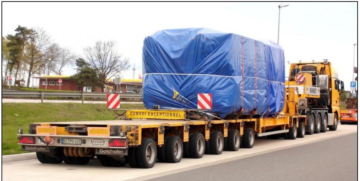
Obrázek 10 Použití plachty při přepravě nadměrného nákladu
