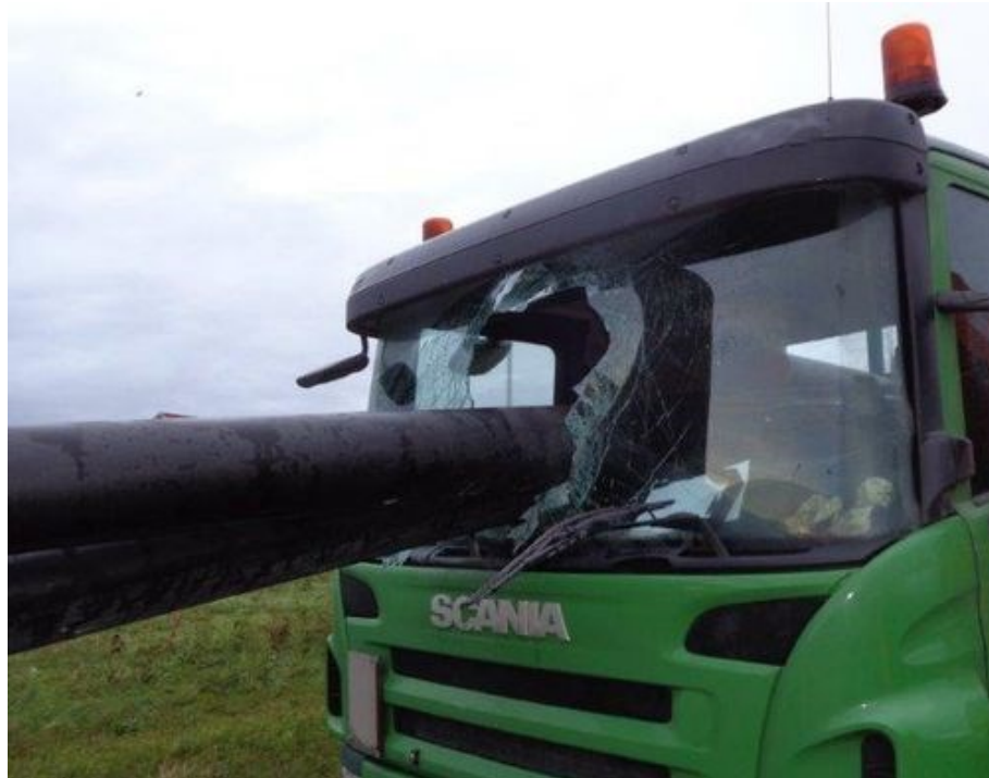
Obrázek 7 Nedostatečně zajištěný kovový tubus
