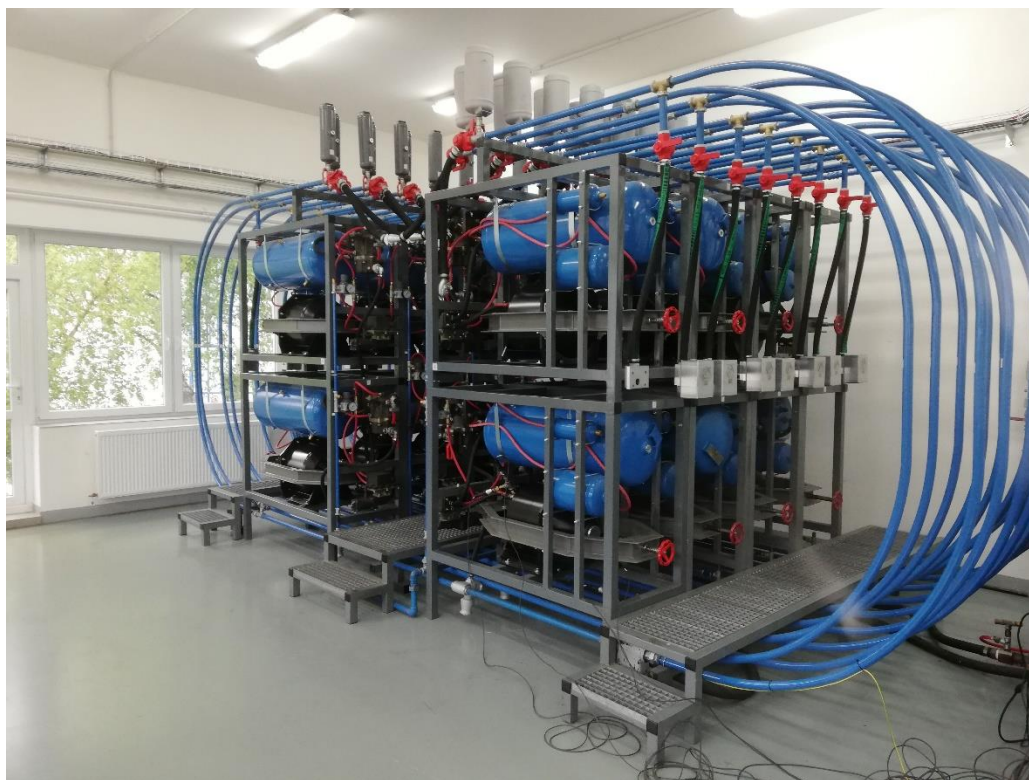
Obrázek 38 – 16-ti vozový zkušební stav DAKO-CZ
