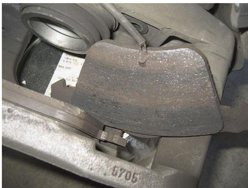
Obrázek 25 – zalití drátu v brzdové desce u automobilu [24]
