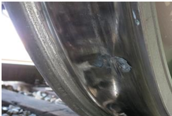
Obrázek 4 – poškození kola vozu – poskytnuto firmou DAKO-CZ
