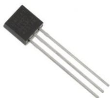
Obrázek 17 – Teplotní čidlo DS18B20 [17]
