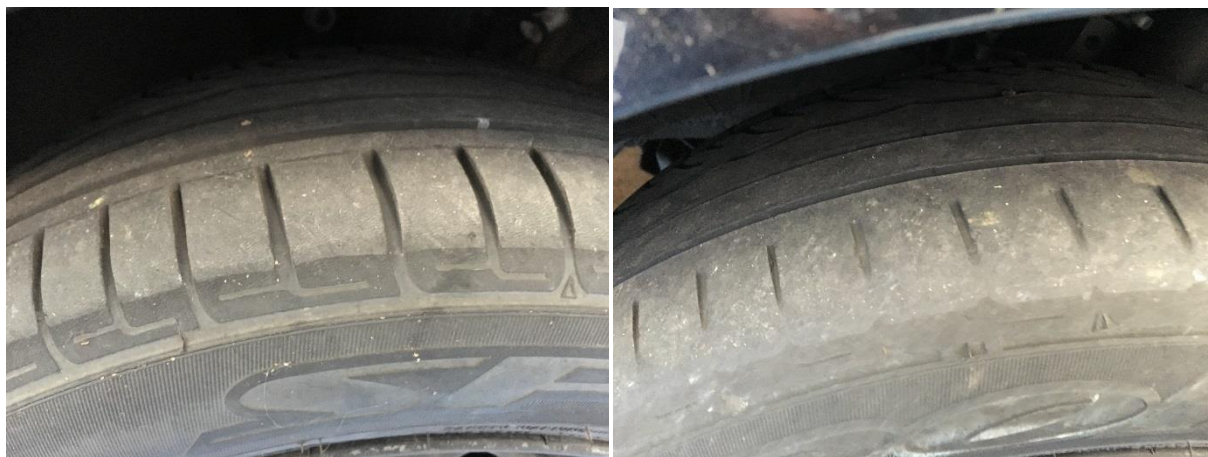
Obrázek č. 20 Rozdíl v opotřebení levé (vlevo) a pravé (vpravo) pneumatiky po jízdních zkouškách [autor]
