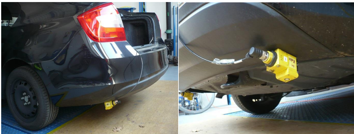
Obrázek č. 17 Umístění a detail snímače klopení karoserie [autor]
