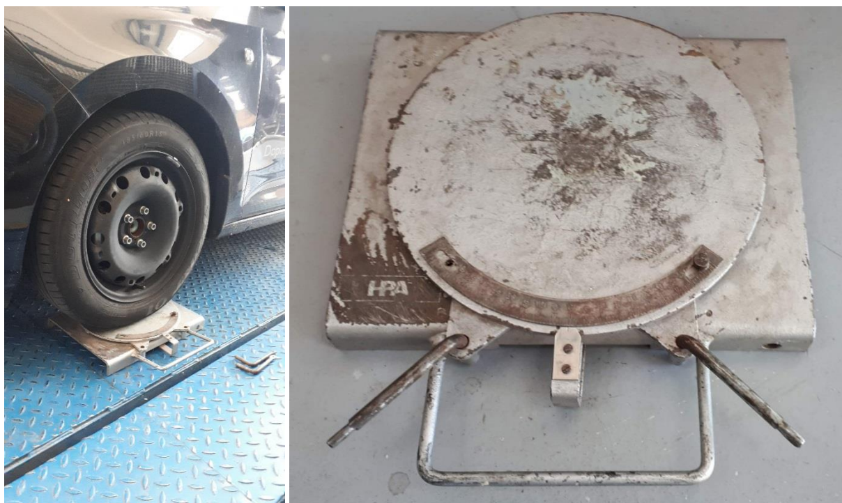
Obrázek č. 5 Měření úhlu rejdu kola a převodového poměru řízení na otočných plošinách
