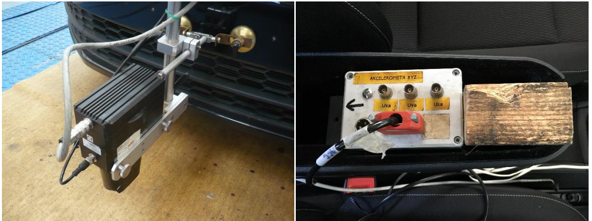
Obrázek č. 16 Detail snímače Correvit S-CE (vlevo) a akcelerometru (vpravo) [autor]
