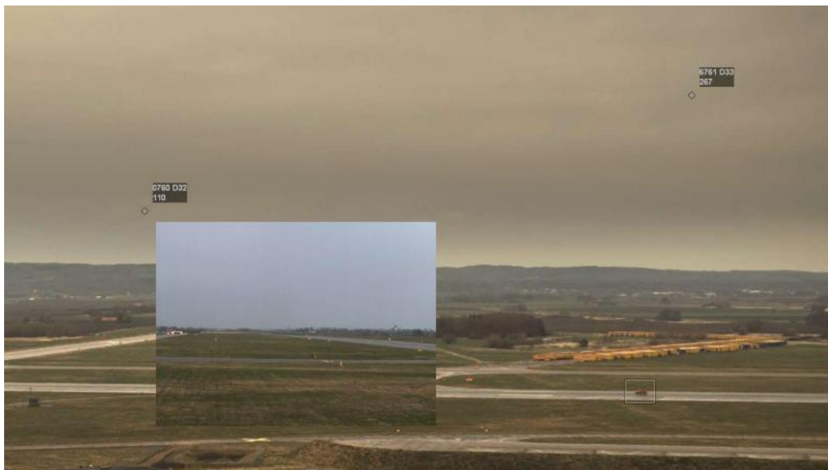
Obrázek 4 Přidělení popisku k zobrazení pomocí sekundárního radaru (Zdroj: SESAR 2014)
