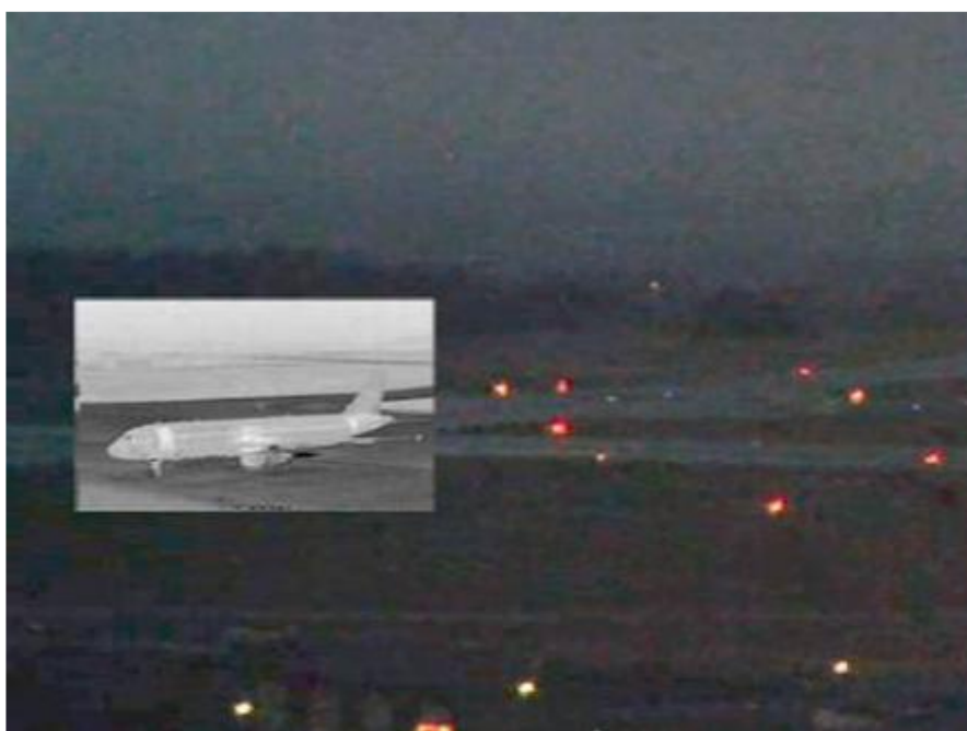
Obrázek 5 Zaměření letadla pomocí IR kamery (Zdroj: SESAR 2014)
