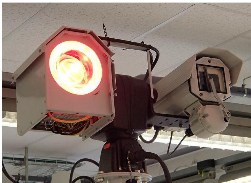
Obrázek 3 Světlomet napojený na PTZ kameru (Zdroj: FÄLT, 2012)
