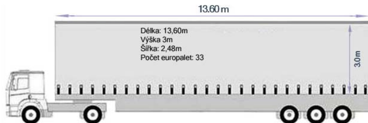
Obrázek 9 Rozměry návěsové soupravy (Vozový park, ©2013)
