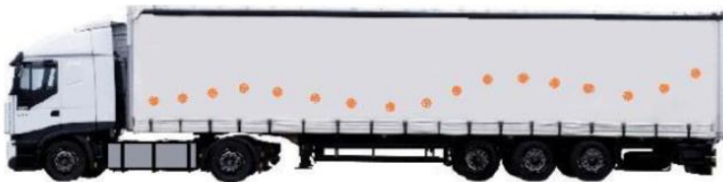
Obrázek 3 Plachtový návěs Tautliner s výškou úložného prostoru 2,7 m (Trucker.EU, 2009)
