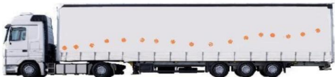
Obrázek 4 Plachtový návěs Tautliner Mega s výškou úložného prostoru 3 m (Trucker.EU, 2009)
