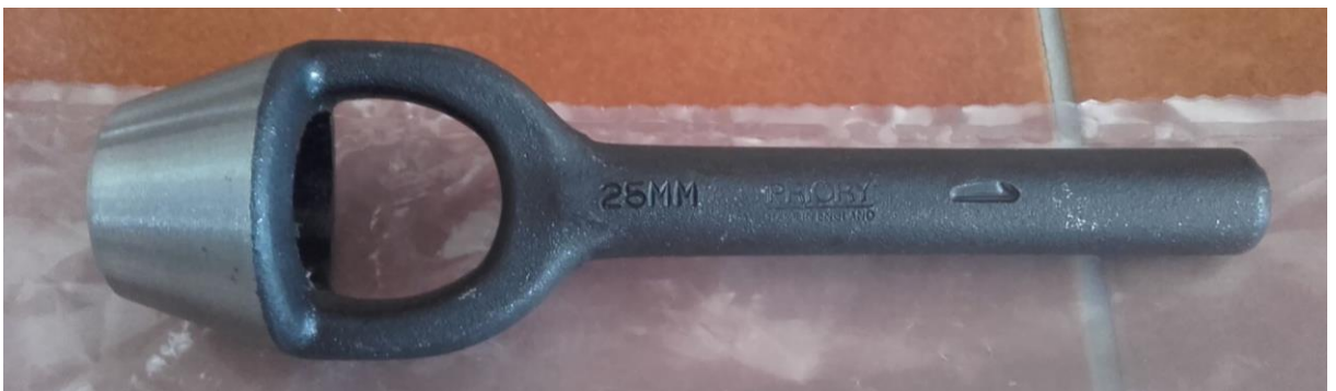
Obrázek 12 - Fotografie raznice k přípravě terčíků kožních preparátů [22]
