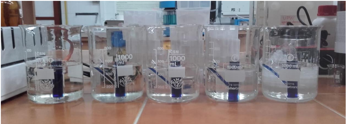
Obrázek 13 - Testování těsnosti difuzních komor typu 1 s klemou typu A [22]
