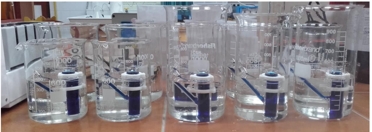
Obrázek 14 - Testování těsnosti difuzních komor typu 1 s klemou typu B [22]
