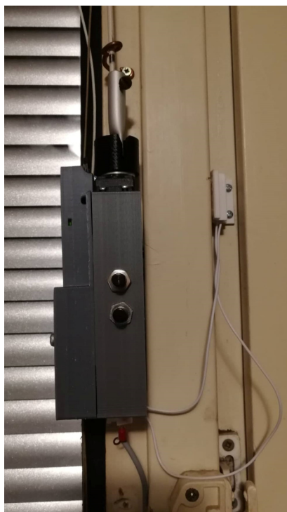
Obr. 1.6 – Umístění jednotky pro ovládání žaluzií a detekci otevřeného okna
