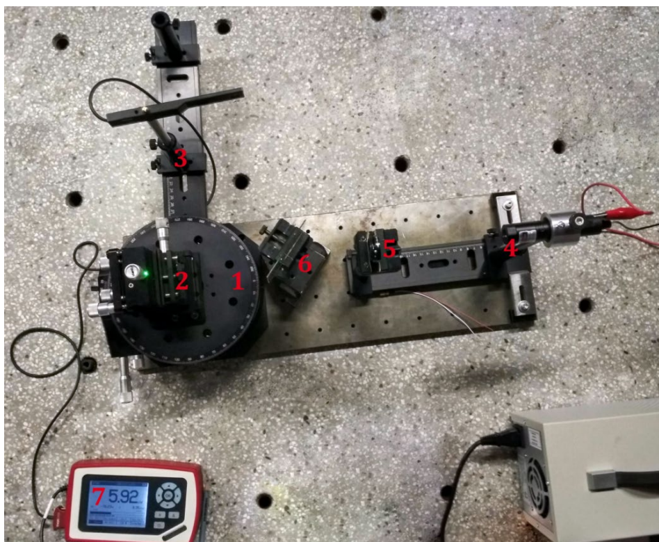
Obrázek 10: Popis zařízení pro měření difrakční účinnosti
