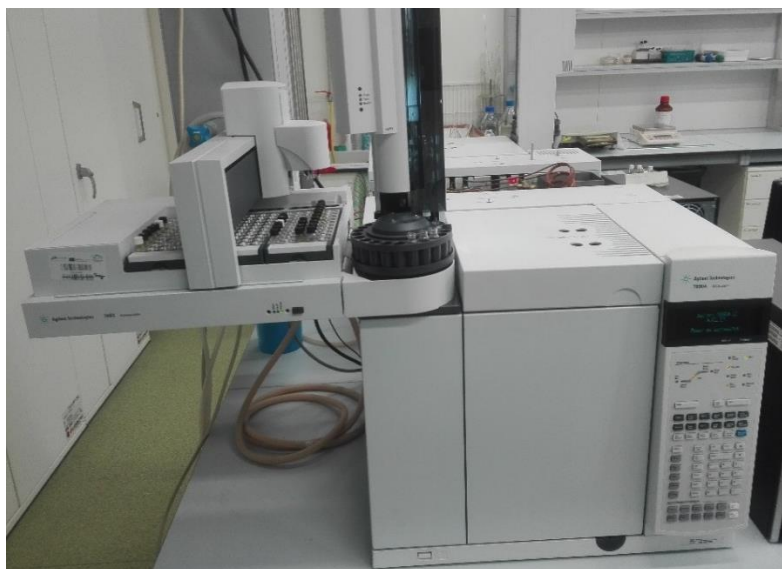
Obrázek 17 GC Agilent Technologies 7890A s autosamplerm
