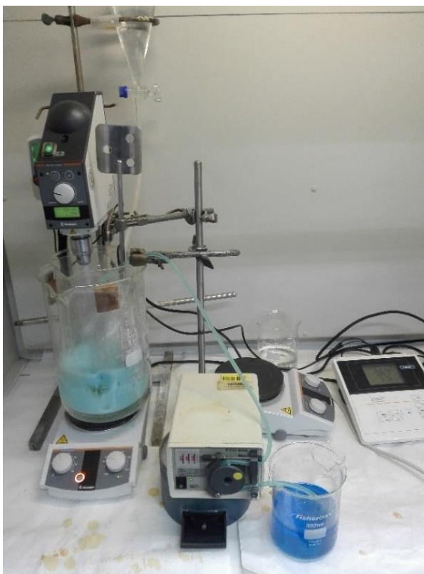
Obrázek 11 Srážecí aparatura pro přípravu hydrotalcitů
