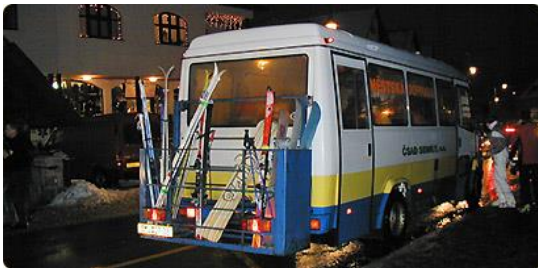
Obrázek 1 Ukázka úpravy skibusu pro převoz lyží zdroj: http://www.harrachov.cz/skibus.asp
