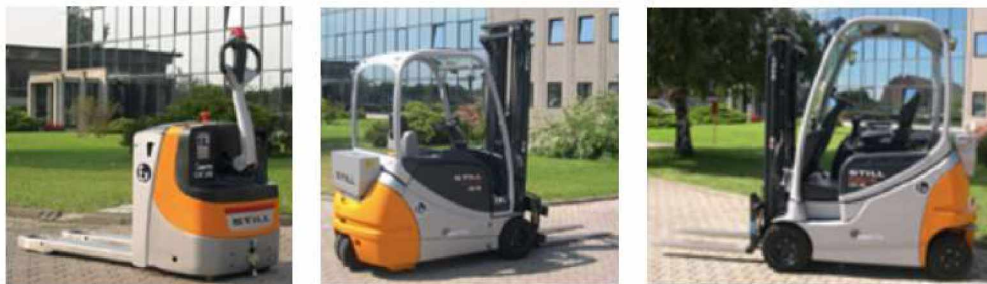
Obrázek 8 Vozík EXU, Vozík RX 60 a RX 20 s vybavením pro nasazení v prostředí s nebezpečím exploze (STILL, 2018)
