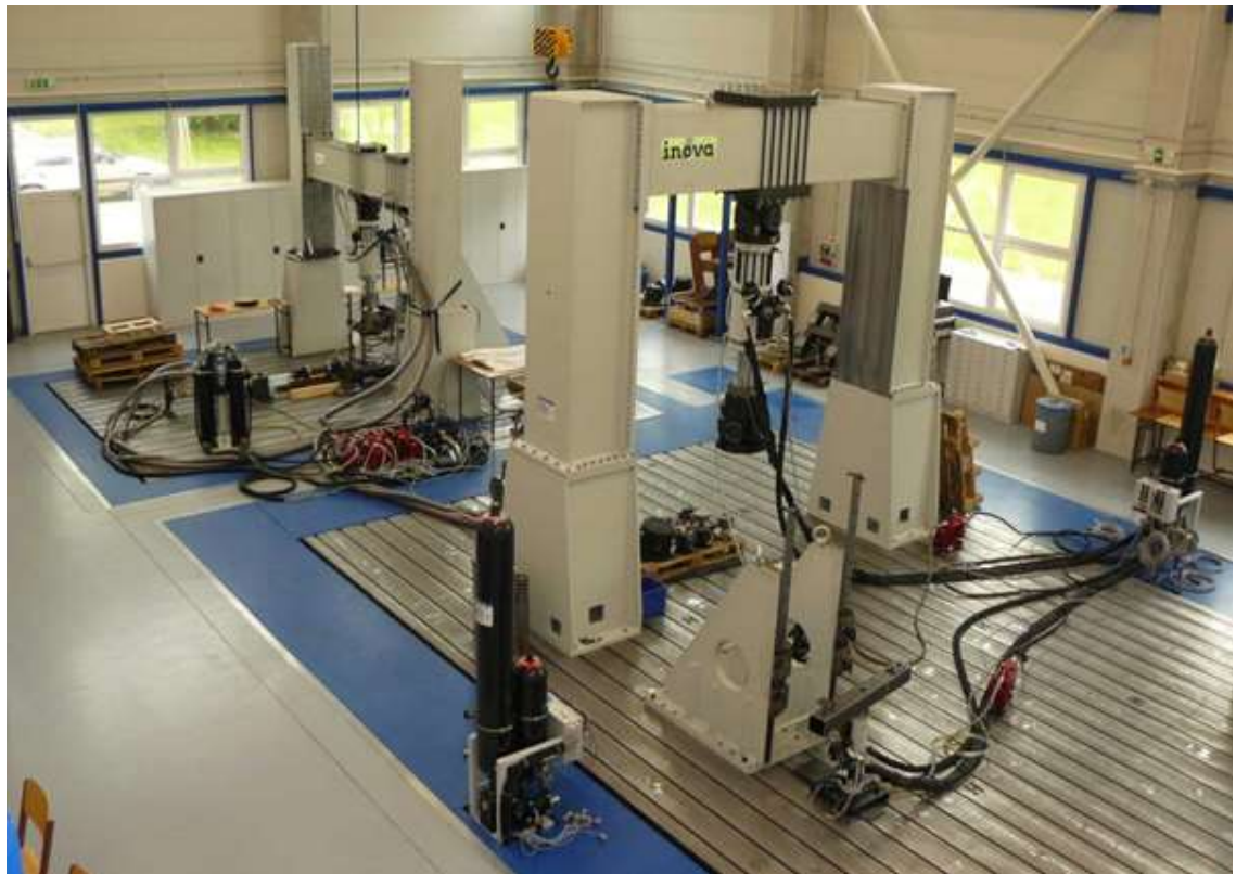
Obrázek 24: Dynamický zkušební stav VVCD
