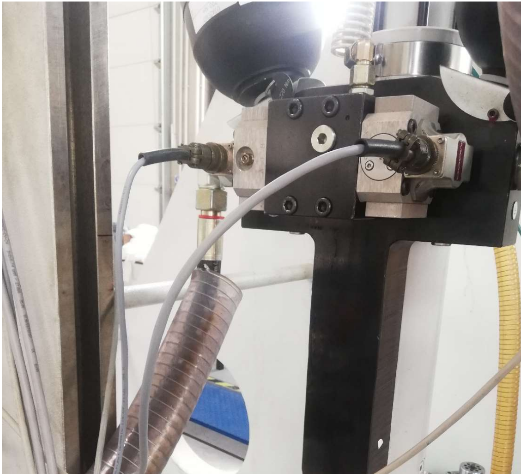
5: SCA deska na válci se servoventily Moog a přívodní hadicí
