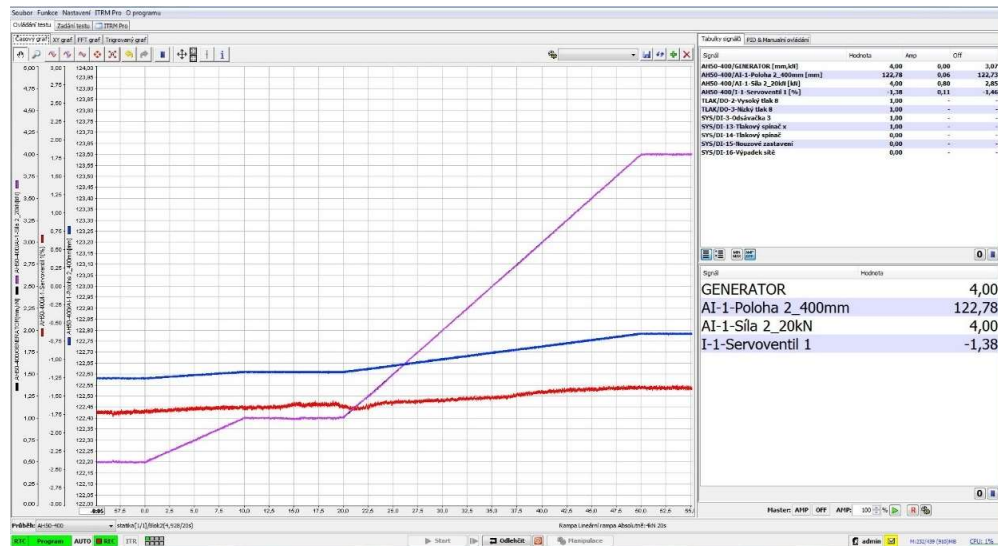
Obrázek 30: Průběh začátku statické zkoušky (fialová čára zobrazuje sílu, modrá polohu a červená odpovídá servoventilu)
