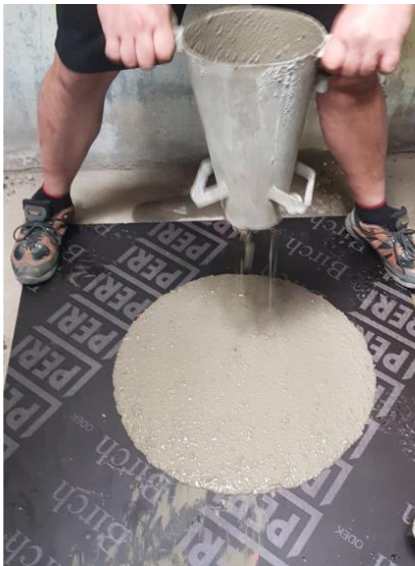
Obrázek 12 Průběh zkoušky rozlitím (vzorek bez urychlovače)
