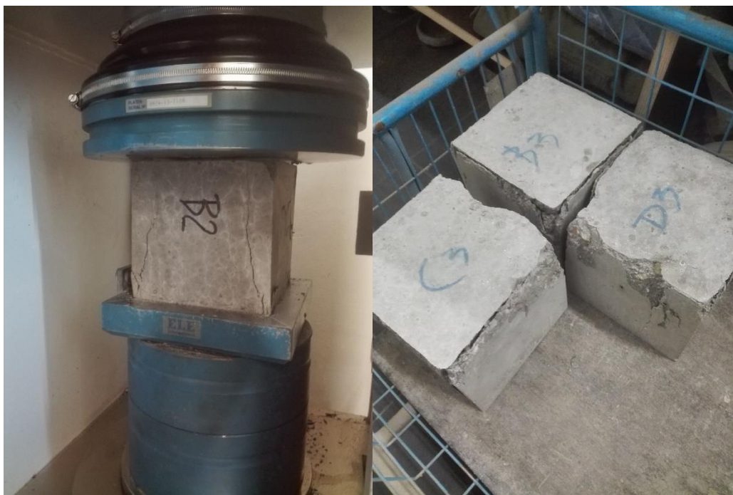
Obrázek 16 Zkoušení pevnosti v tlaku
