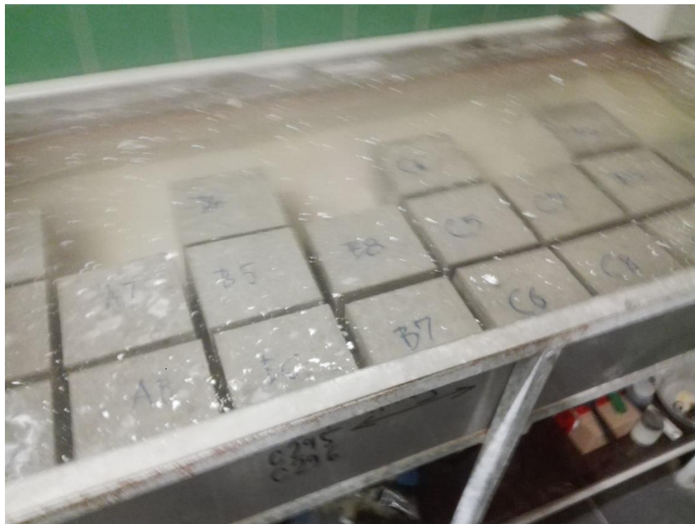
Obrázek 15 Uložení zkušebních těles ve vodní lázni
