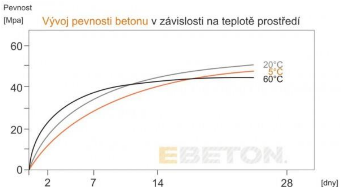
Obrázek 2 Vývoj pevnosti betonu v závislosti na teplotě prostředí [25]
