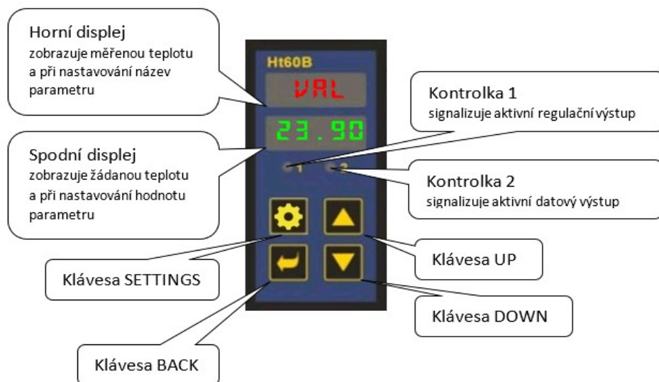
Obr. 2.1 – Popis panelu regulátoru
