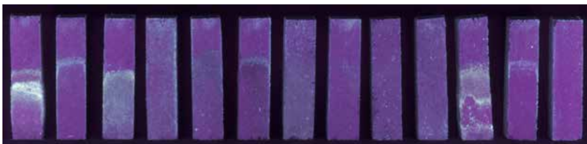
Obr. 7 Srovnání zkušebních těles napouštěných roztoky zkoumaných solí, UV fluorescenční fotografie (seřazení těles dle obr. 5). Foto: Ivana Studeník Milionová.
