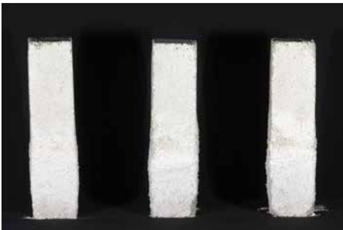
Obr. 1 Zkušební tělesa po aplikaci 3 cyklů 20 ml roztoku síranu sodného o koncentraci 16,66 % hm., fotografie ve viditelném světle. Foto: Ivana Studeník Milionová.
