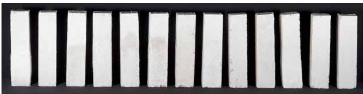
Obr. 6 Srovnání zkušebních těles napouštěných roztoky zkoumaných solí, fotografie ve viditelném světle (seřazení těles dle obr. 5). Foto: I. Studeník Milionová.
