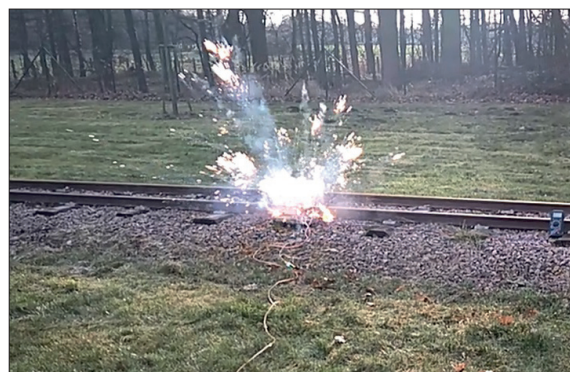
Obr. 1. Spontánní uvolnění energie lithiového článku z mobilního telefonu při jeho přebíjení
