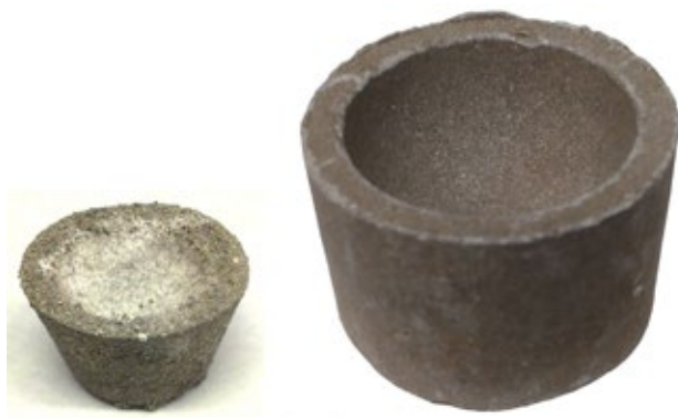
Obr. 3. Vzhled kapelky vyrobené dle Erckera (vlevo) a průmyslově vyráběné kapelky (vpravo) před kupelací. Foto autoři.
