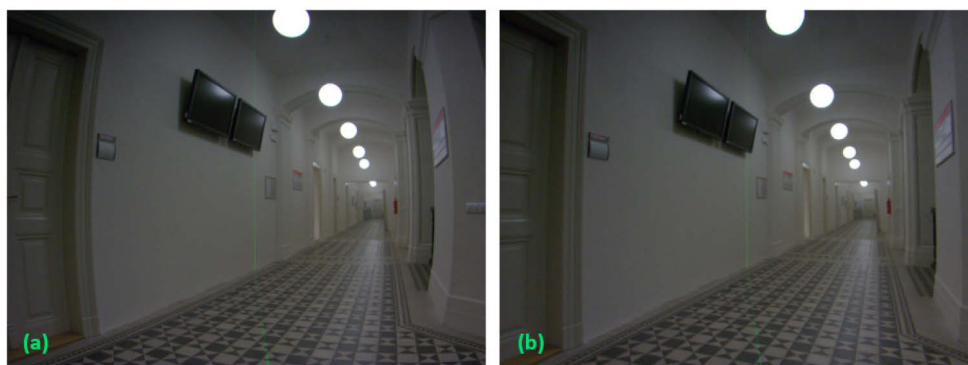
Obr. 3.9 – Ukázka barelového zkreslení, (a) zkreslený obraz, (b) korigovaný obraz
