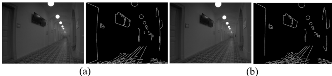
Obr. 3.10 – Ukázka hranové detekce Canny na vstupním obraze, (a) sDist = 1 , (b) sDist = 1,8
