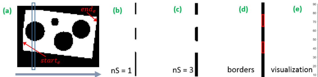
Obr. 6.25 – Vizualizace úrovněového obrazu, (a) vstupní obraz s vyznačeným výběrovým oknem, počátkem a koncem, (b) část s krokem 1 px, (c) část s krokem 3 px, (d) vyznačené hranice, (e) vizualizace
