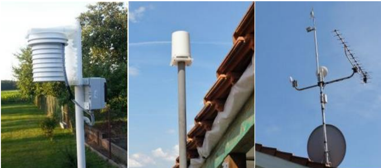
Obr. 7 Meteostanice: čidlo teploty a vlhkosti, srážkoměr, anemometr + UV senzor
