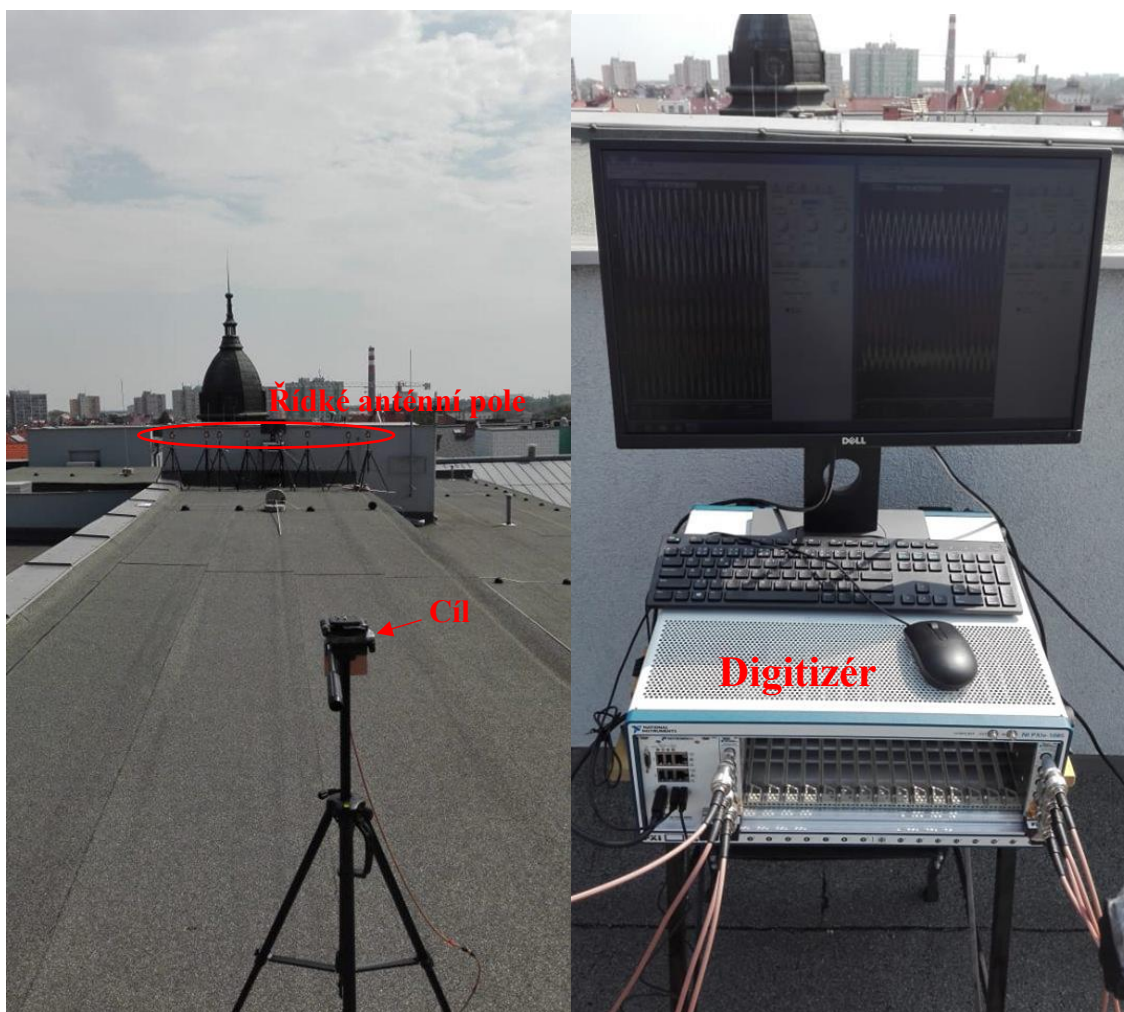
Obrázek 81 - Ukázka pracoviště pro ověřovací měření
