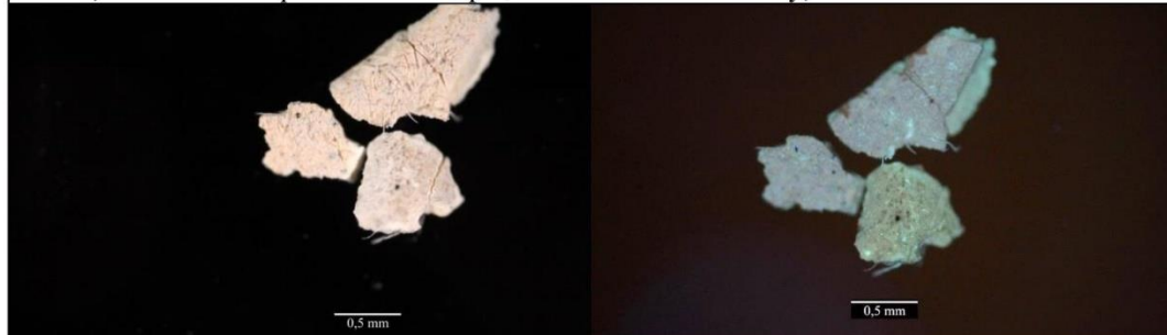
Obr. 7, 8 9232/Vz.2. optická mikroskopie, vzorek ze spodní strany, bílé světlo a UV fluorescence.
