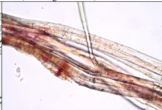
Obr. 6, 7 Optická mikroskopie, procházející světlo, roztok fluoroglucinu, zvětšení 500 ×.
