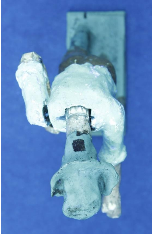
Obr. 57. Zkouška odstranitelnosti laku, UV záření
