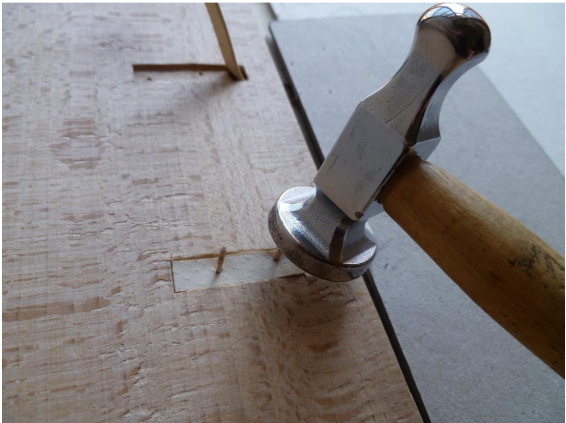
Obrázek 87: Nasazování desek – vtlačování dřevěných kolíčků
