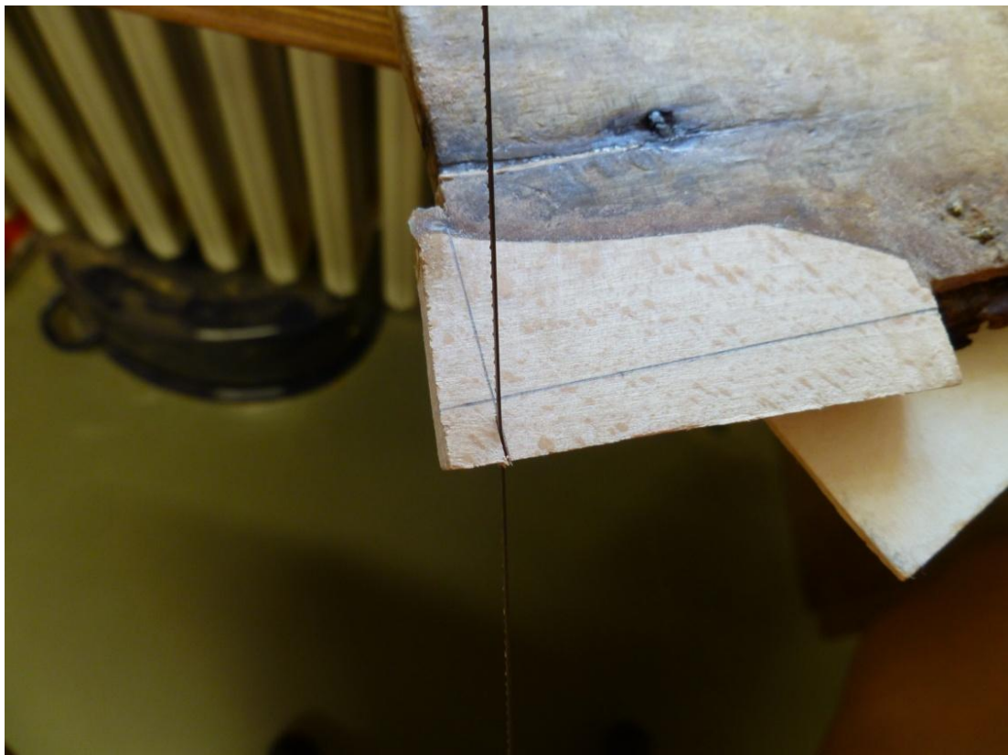
Obrázek 83: Odstranění přebytečných částí doplňku dřevěné desky
