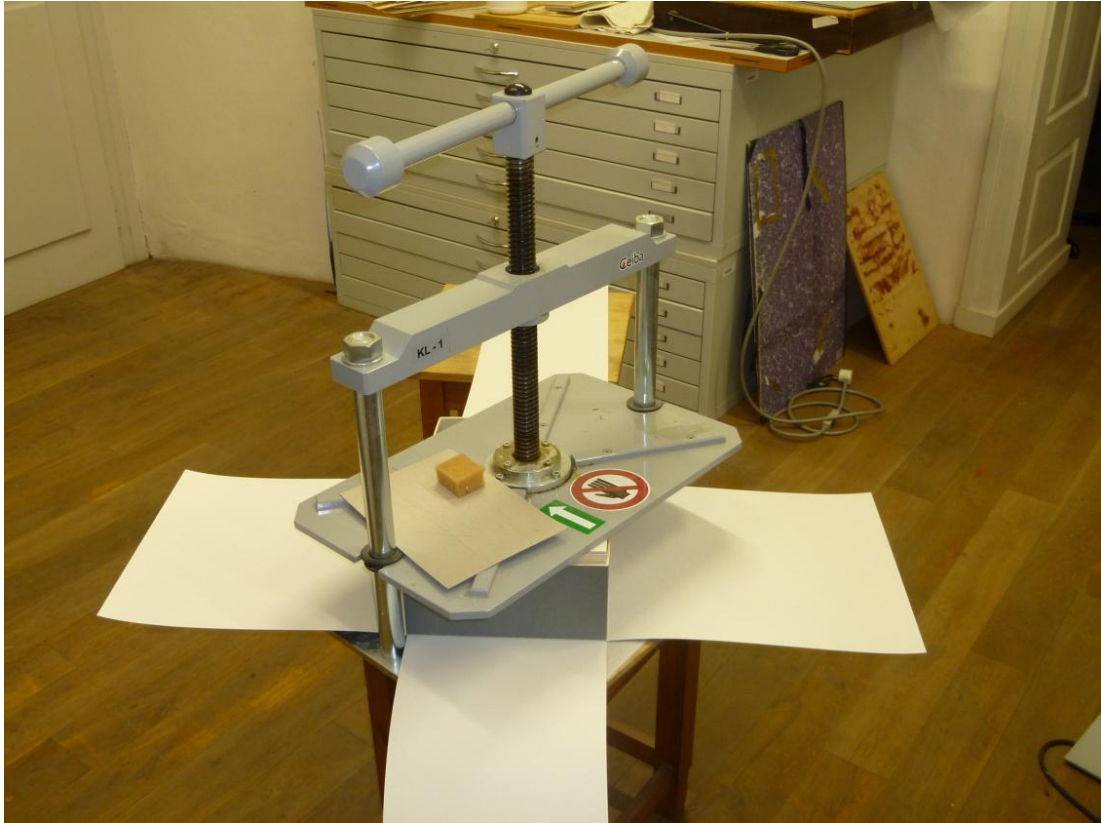
Obrázek 94: Lepení krčku krabice ke kříži
