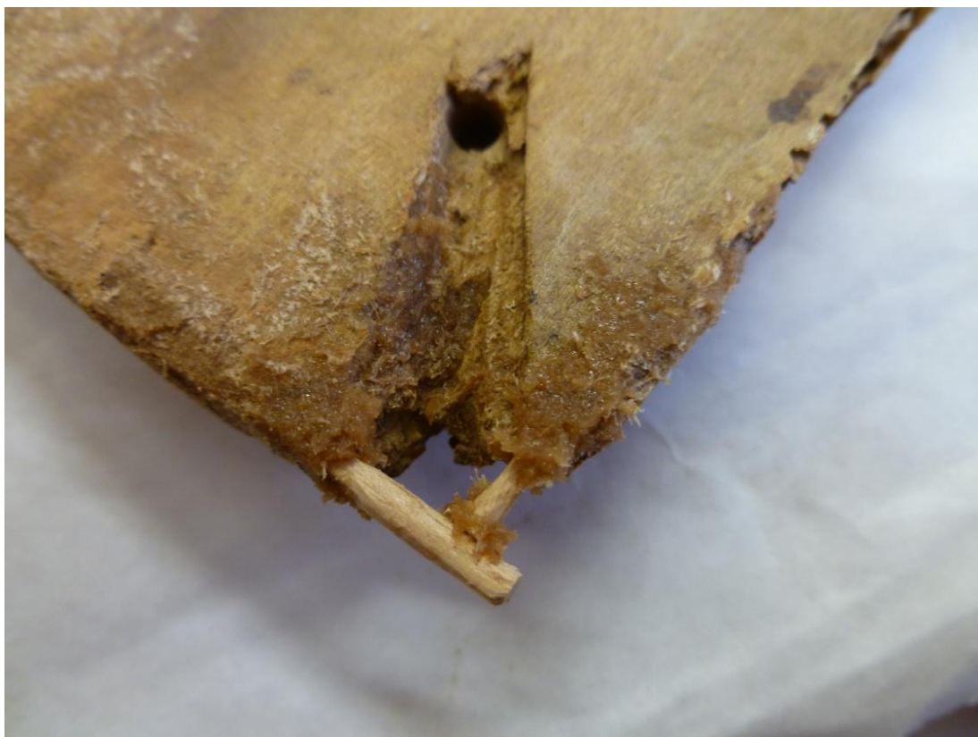
Obrázek 80: Tmelení menší ztráty dřevěné desky
