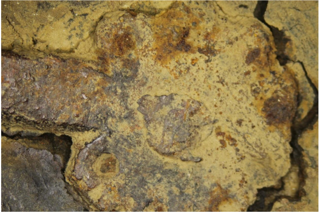
Obrázek 47: Kování ze slitiny železa-stav před restaurováním
