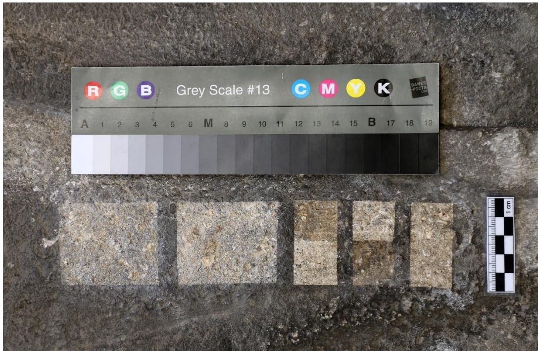
Obr. 37 Restaurátorský průřez-žkoušky redukce sádrovcové krusty
