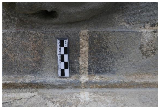
Obr. 19 Postament, zkouška S9 čištění a redukce sádrovcové krusty se zbytkem cementového šlemu, pomocí laseru
