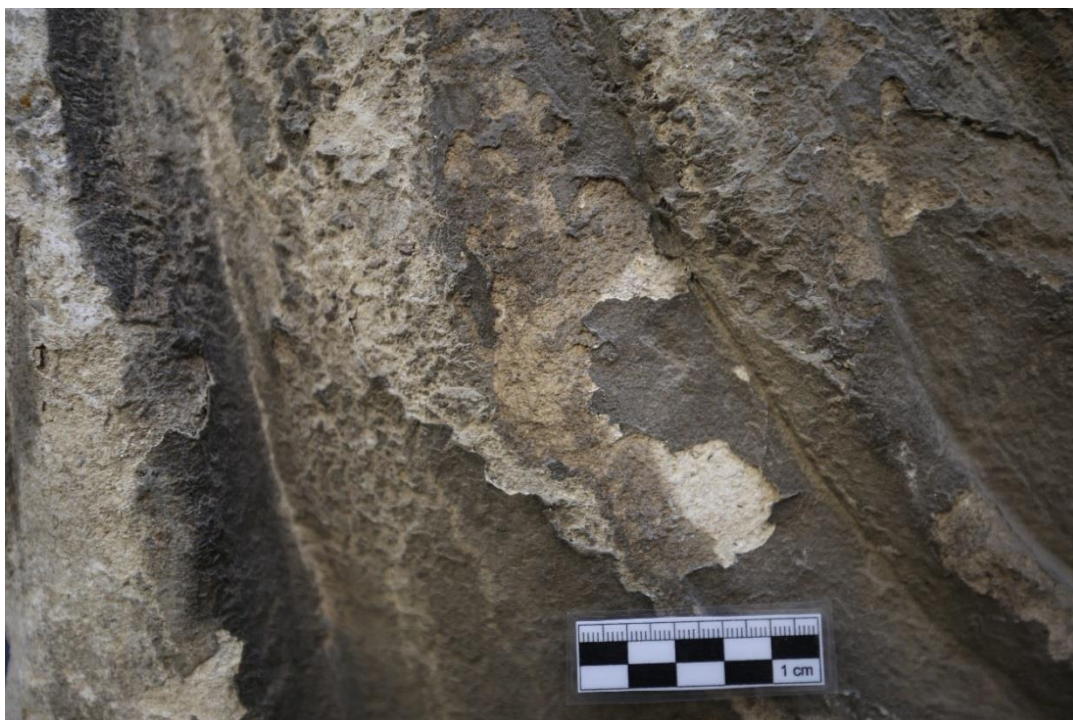
Obr. 45 Stav před čištěním sádrovcové krusty-detail na záda sochy Jupitera
