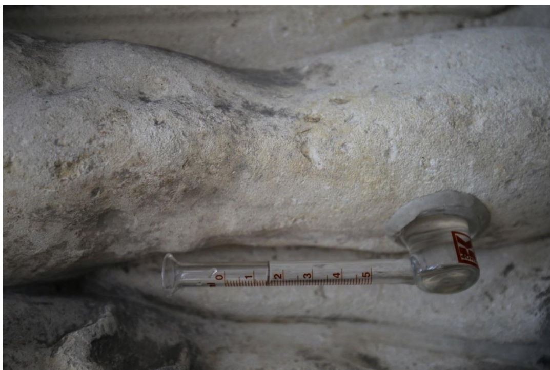
Obr. 30 Restaurátorský průzkum-měření kapilární nasákavosti kamene pomocí Karstenovy trubice
