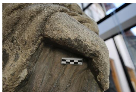
Det. č. 12: Povrchová degradace a křusta
