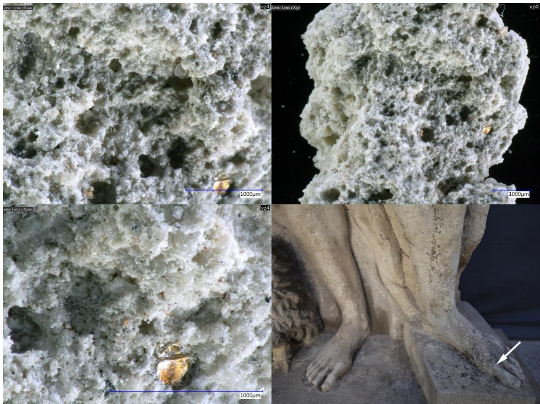
Obr. 34 Restaurátorský prířekum sekundárných cementových tmelů na povrchu sochy Jupitera
