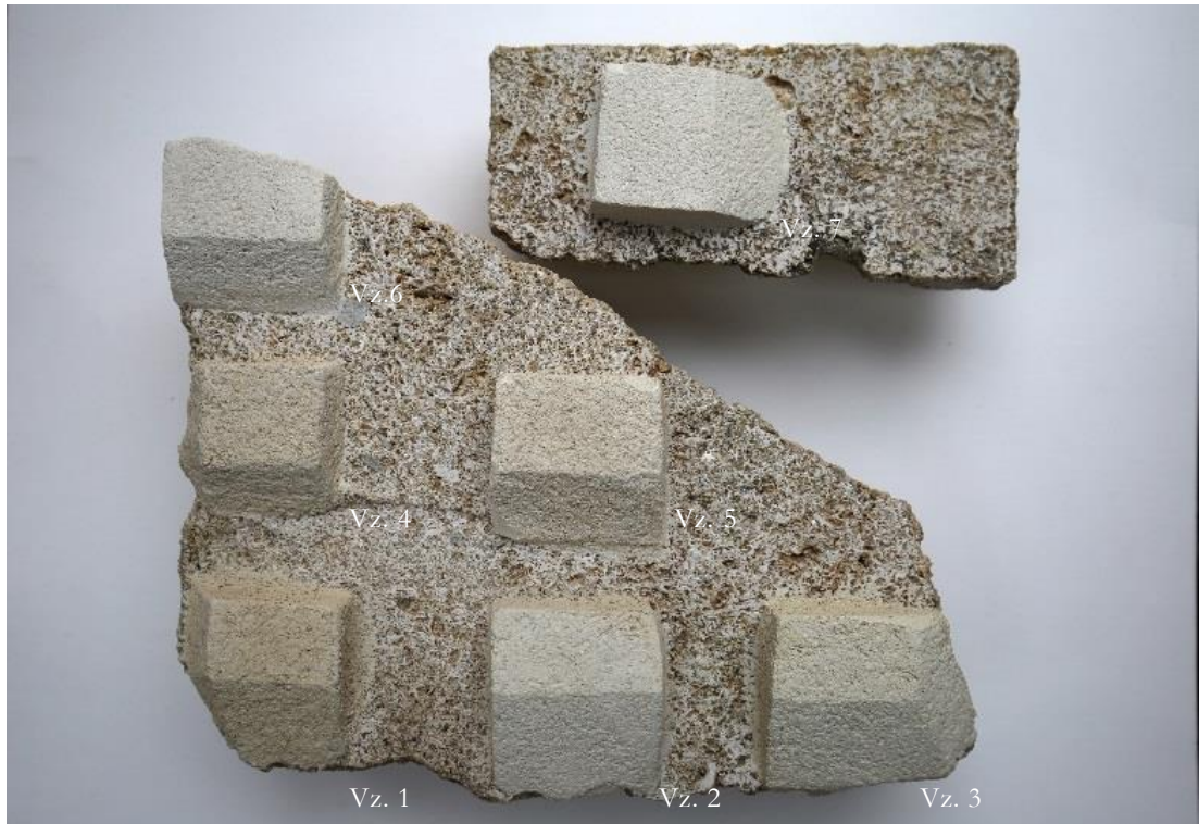
Obr. 20: Zkoušky tmelu byly vytvořeny na základě kombinací poměru různých písku a typů pojiv. Vybraná směs Vz. 5.
