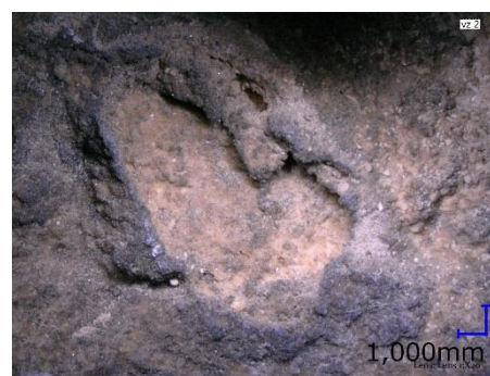
Det. č. 14: Makrosnímek, poškození horniny, vzniku puchýřů, zvětšení 20x
