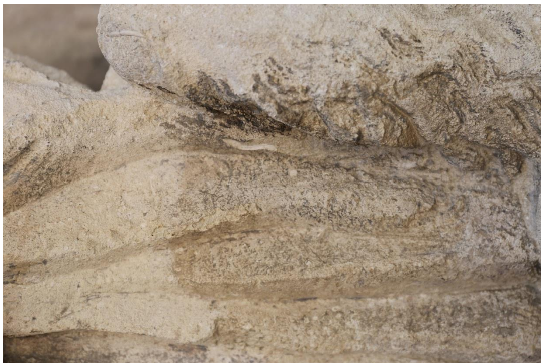
Obr. 48 Stav po očištění povrchu od sádrovcové krusty-detail na drapérii a část orla
