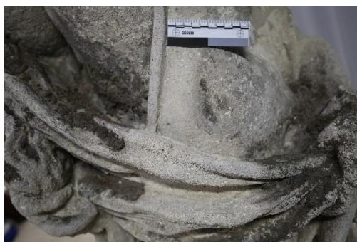
Obr. 14 Draperie a břicho – zkouška očištění kamene od biologické kolonizace pomocí Ajatinu 2 %
