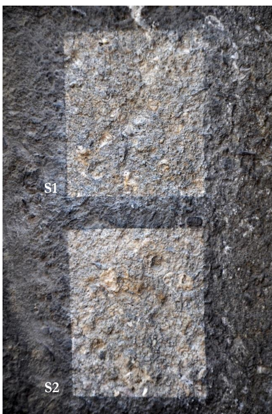
Fotografie dokumentuje zkoušky čištění, provedené pomocí metody mikropískování. Makrosnímek S1 ilustruje zkoušku pomocí dolomitického vápence frakce 300µm, makrosnímek S2 zobrazuje čištění pomocí korundového prachu frakce 220µm. Makrofotografie byly pořízeny pomocí digitálního mikroskopu Keyence VHX-900, o zvětšení 50x
