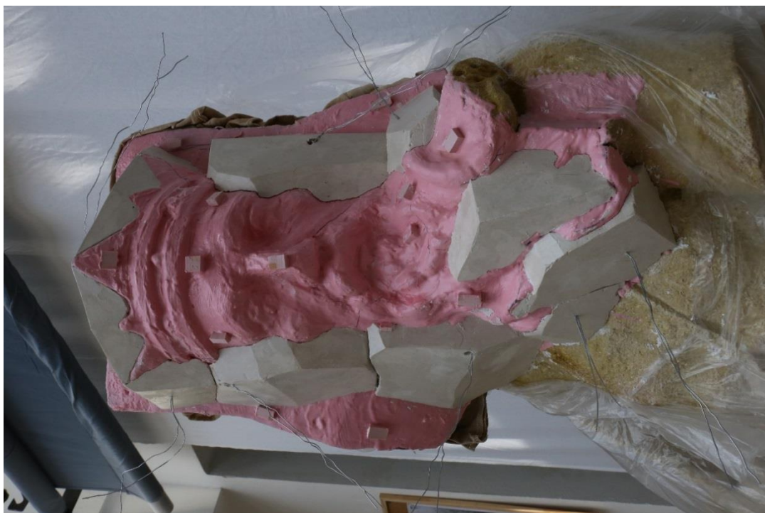
Obr. 71 Výroba klínové formy-průběh prací
