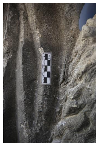
Det. č.10: Degradovaný povrch, pokrytý sádrovcovou krustou, detail
