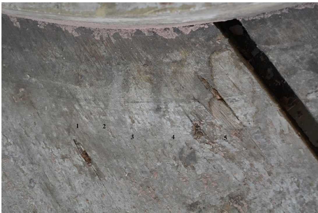
Obr. 50 Zkoušky čištění dřevěná podložka – 1 štětec, 2 kaučuková guma, 3 plastická guma Faber-Castell, 4 plastická guma Koh-i.nor, 5 Arte-Mundit
