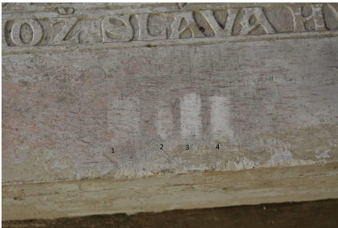
Obr. 52 Zkoušky čištění sádra- 1 štětec, 2 kaučuková guma, 3 plastická guma Faber-Castell, 4 plastická guma Koh-i-nor
