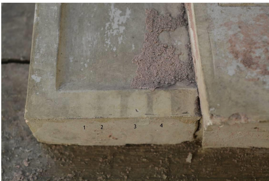
Obr. 51 Zkoušky čištění sádra s povrchovou úpravou- 1 štětec, 2 kaučuková guma, 3 plastická guma Faber-Castell, 4 plastická guma Koh-i.nor
