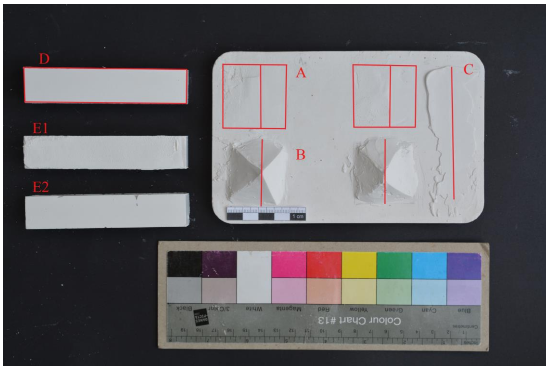
Obr. 70 Tmelý směsí 1, stav po vytvrdnutí tmelů. Levá polovina plochy zkoušek byla přebroušena (A, B, C). Vlevo vzorky odlitků s pravidelnými rozměry (nahore vzorek sádra-referenční vzorek bez příměsí (D), uprostřed – vzorek z lícové strany (E1), dole – vzorek z rubové strany (E2)).
