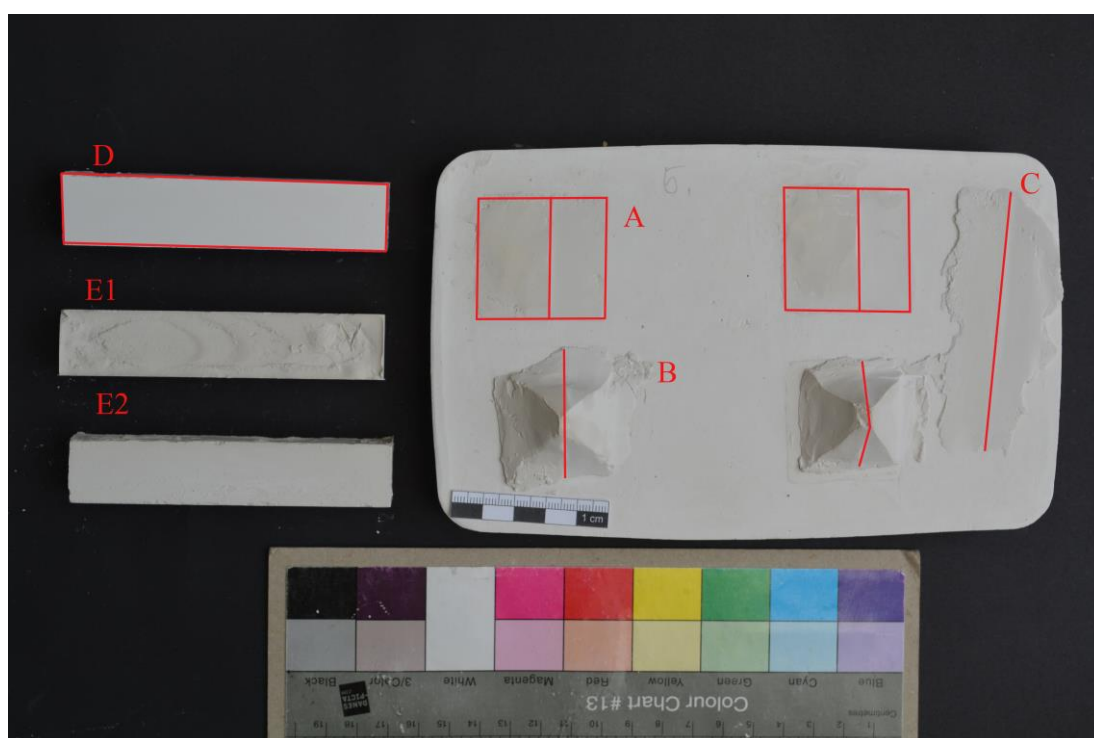
Obr. 74 Tmely směsi 5, stav po vytvrdnutí tmelů. Levá polovina plochy zkoušek byla přebroušena (A, B, C). Vlevo vzorky odlitků s pravidelnými rozměry (nahore vzorek sádra-referenční vzorek bez příměsí (D), uprostřed – vzorek z lícové strany (E1), dole – vzorek z rubové strany (E2)).
