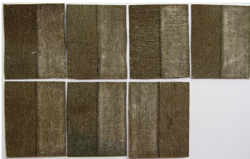
Obr. 97 Stav rubu vzorků po ukončení odžehlovacích zkoušek, do poloviny očištěny technickým benzínem
