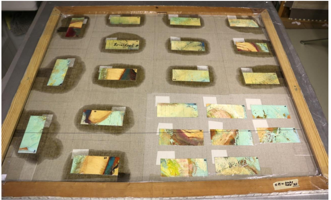
Obr. 83 Průběh nažehlování všech vzorků na nízkotlakém nažehlovacím stole, u vosko-pryskyřičních směsí můžeme sledovat, jak mnoho se rozlily do okolí podložky
