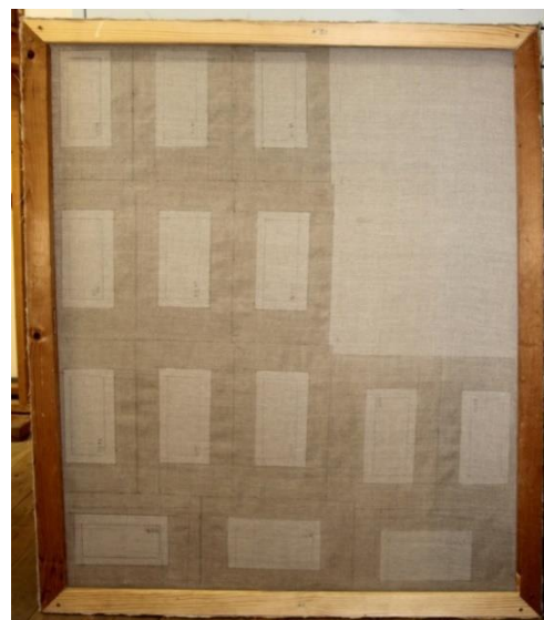
Obr. 82 Připravené podložní lněné plátno pro nažehlené všech vzorků, tmavé části značí izolaci Klucelem G
