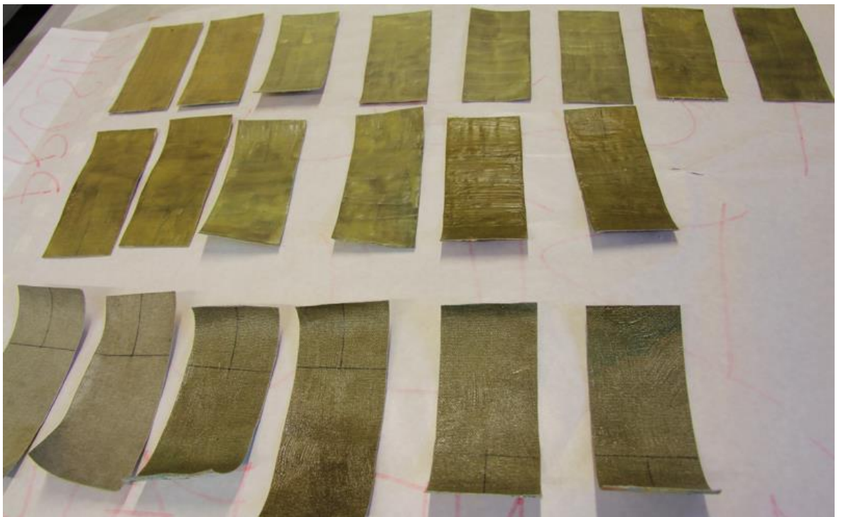
Obr. 91 Ruby všech vzorků opatřené dvěma nátěry adheziva – příprava na rentoaláž
