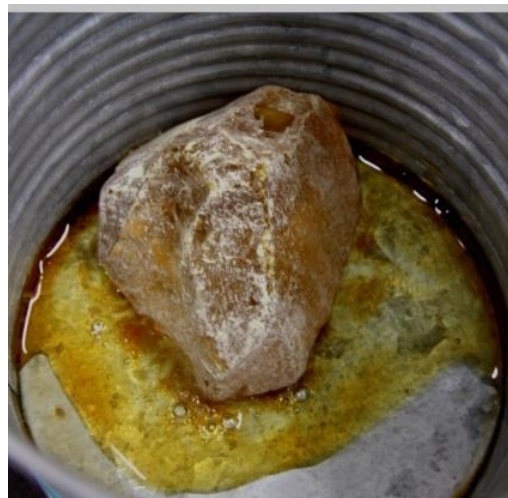
Obr. 73 Roztavení pryskyřice při procese míchání směsi
