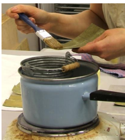
Obr. 79 Nanesení voskopryskyřičné směsi po rozpuštění ve vodní lázni, nad vařičem
