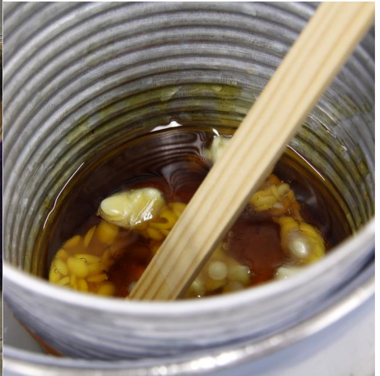
Obr. 89 Pracovní snímek při míchání jednotlivých směsí – roztavení pryskyřice za současného míchání na vařiči Obr. 90 Detailnější snímek na rozpouštění a smísení včelího vosku s již roztavenou pryskyřicí
