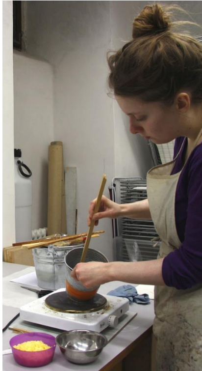
Obr. 89 Pracovní snímek při míchání jednotlivých směsí – roztavení pryskyřice za současného míchání na vařiči Obr. 90 Detailnější snímek na rozpouštění a smísení včelího vosku s již roztavenou pryskyřicí
