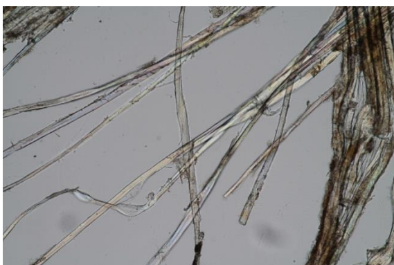
Vlákna textilní podložky, bílé procházející světlo, fotografováno při zvětšení 500x
