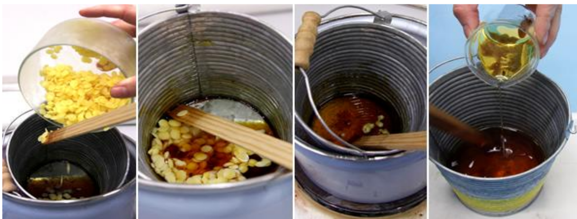
Obr. 74 Pracovní snímky: při postupu namíchání vosko-pryskyřičných směsí, zleva vsypání včelího vosku do předem roztavené pryskyřice, postupné rozpouštění vosku v pryskyřici do úplného rozpouštění; napravo vylévání terpentýnového oleje pro směs č. 07.
