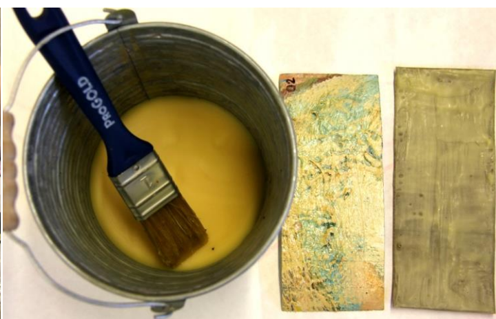
Obr. 78 Stav po vytvrdnutí voskopryskyřičného adheziva, pohled na rub vzorku směs č. 02
