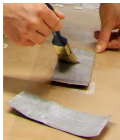
Obr. 77 Nanesení akrylátových lepidel Lascaux na rub vzorku
