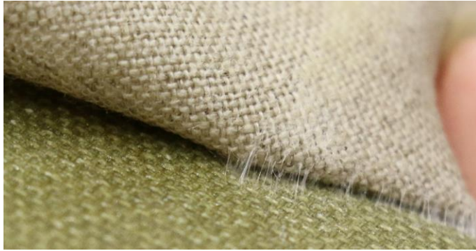
Obr. 98 Pohled na odtržení nového plátna od vzorku, adhezivum Lascaux
