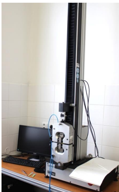
Obr. 86 Přístroj LabTest 5.030-2 na VŠCHT Praha umožňující odtrhávací zkoušky
