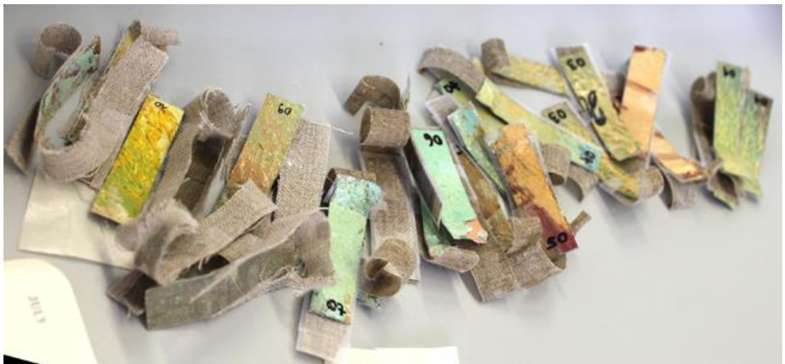
Obr. 94 Stav všech vzorků po proběhlých otrhávacích zkouškách
