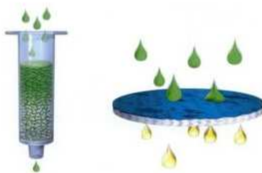
Obr. 13 Dávkování vzorku na A) klasickou SPE kolonku, B) na disk [90].
