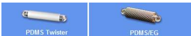
Obr. 12 Twister míchadla. Twister s polydimethylsiloxanem (PDMS) stacionární fází (vlevo) a Twister s polydimethylsiloxanem (PDMS)/ ethylenglykolem (EG) – kopolymer na inertní kovové mřížce pro mechanickou stabilizaci [87].
