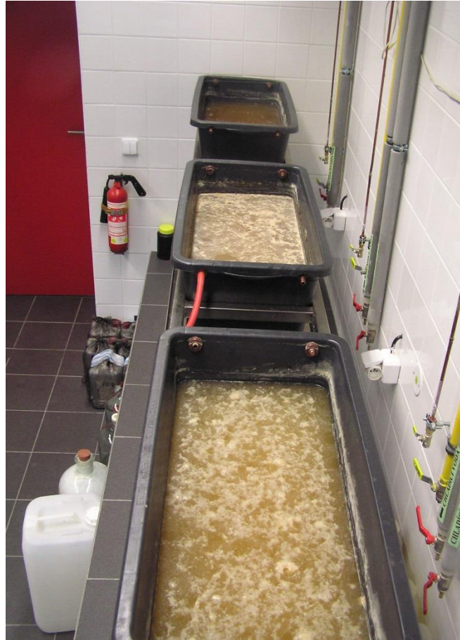
Obr. 3.12 Vsádkové experimenty s aktivovanými kaly v nádržkách (nejblíže nádržka s kalem Biopel., uprostřed s kalem z klasické BČOV – Kal 2 a nejvzdálenější s kalem z denitrifikační jednotky ČOV – Kal 1)
