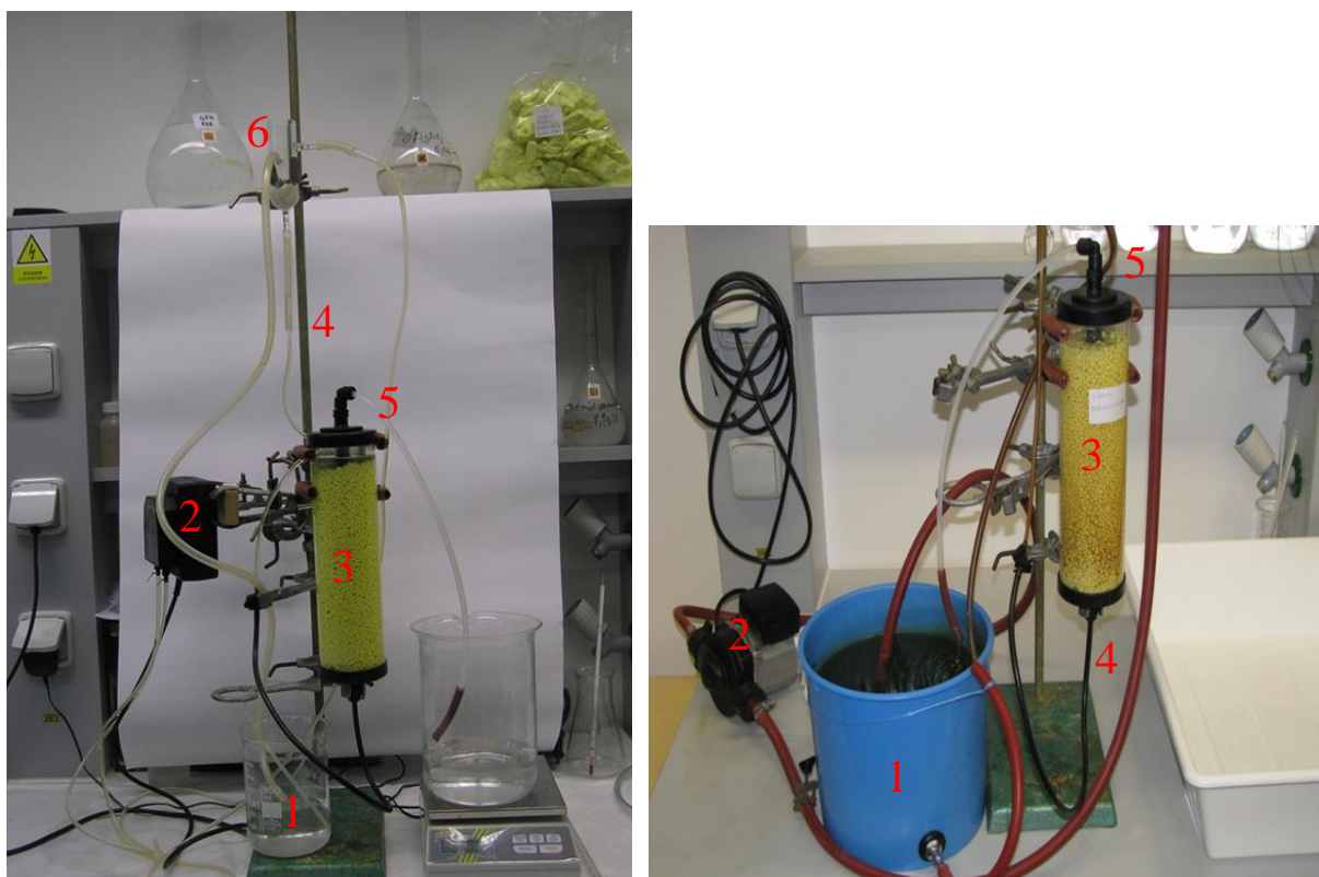
Obr. 3.11 Zapojení sírového denitrifikátoru (vlevo průtočný režim, vpravo režim cirkulační): 1 – zásobník modelové vody, 2 – čerpadlo, 3 – kolona naplněna sírou, 4 – přívod modelové vody, 5 – výstup z kolony, 6 – přepadová nádobka (na obrázku vpravo není pouze vidět)
