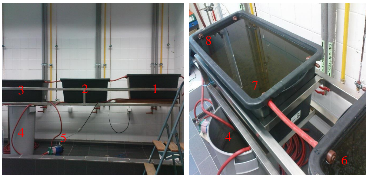
Obr. 3.7 Průtočný systém nádržek pro kontinuální experiment s rybníční kulturou: 1, 2, 3 – nádržky, 4 – zásobník, 5 – čerpadlo, 6 – výtok ze 2. nádržky, 7 – nátok do 3. nádržky, 8 – výtok ze 3. nádržky zpět do zásobníku
